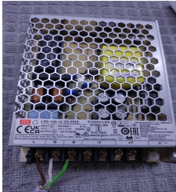
Εικόνα 52: Τροφοδοτικό Αντλιών και Peltier [94]
