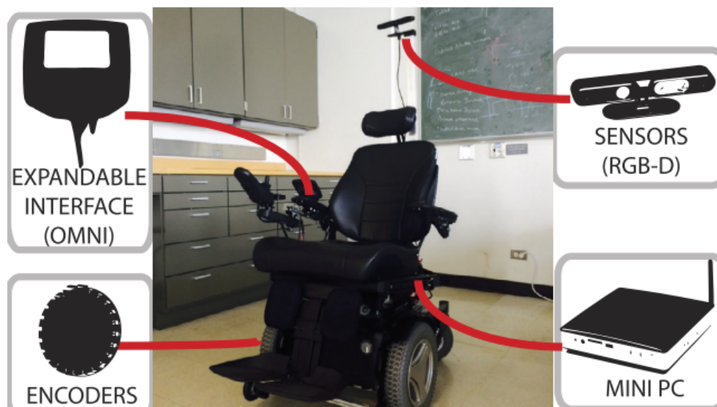
Εικόνα 18. Το NURIC Smart Wheelchair που αποτελείται από αισθητήρα RGB-D, mini-PC, πλακέτες μετατροπέα και κωδικοποιητές τροχών. [42]
