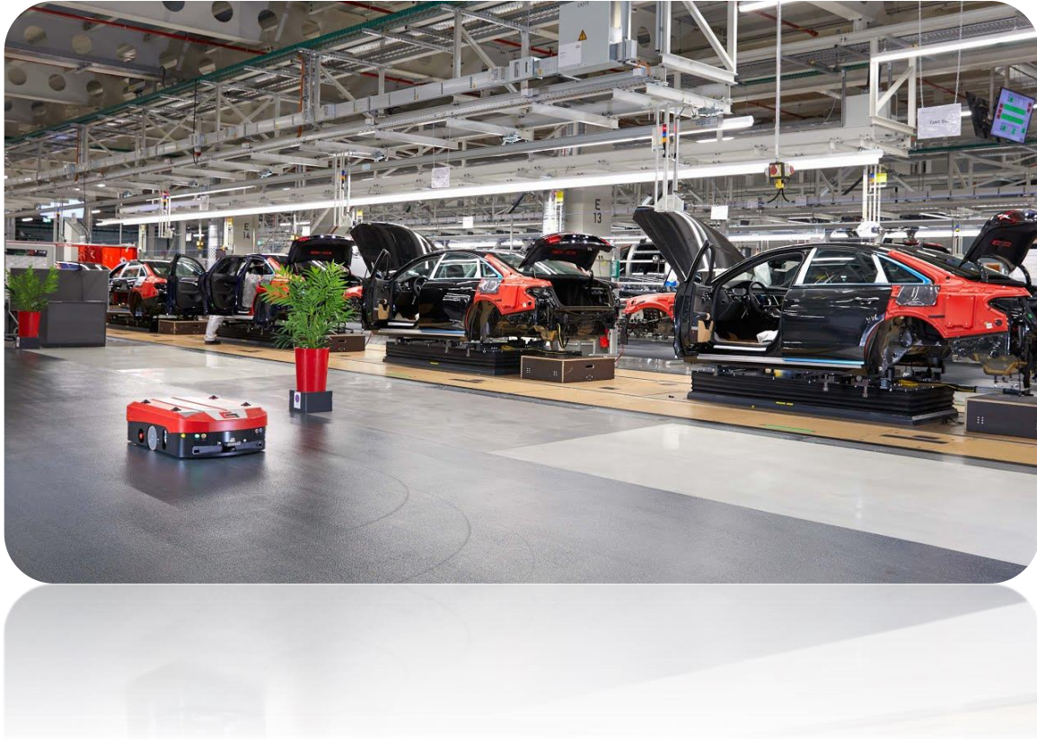
Εικόνα 7: Ρομπότ εξυπηρέτησης ή καθοδήγησης AGV στη διαδικασία συναρμολόγησης
