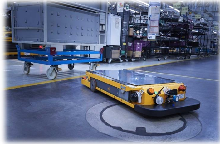
Εικόνα 5: Ρομπότ εξυπηρέτησης για logistics εξοπλισμένα με αισθητήρες επικοινωνίας και καθοδήγησης
