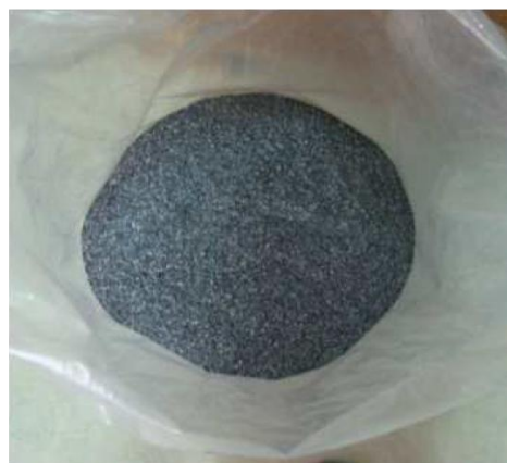
Εικόνα 6.2. Θρυμματισμένες κυψέλες έτοιμες για ανακύκλωση και σκόνη πυριτίου μετά την ανακύκλωση [104]
