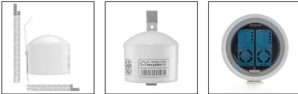
Εικόνα 3.2.1 Η συσκευή PurpleAir-II-SD (Πηγή: https://www2.purpleair.com/products/purpleair-pa-ii?variant=40067691741281 , προσπελασιμότητα 7 Ιουνίου 2023)
