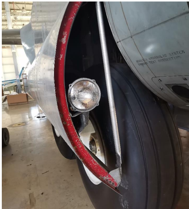
Εικόνα 6.14: Φώτα τροχοδρόμησης σε αεροπλάνο (Taxi light).
