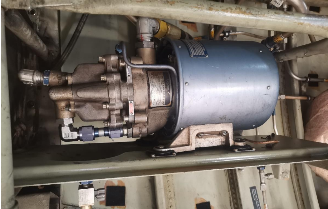
Εικόνα 4.42: Τριφασική αντλία υδραυλικού συστήματος.
