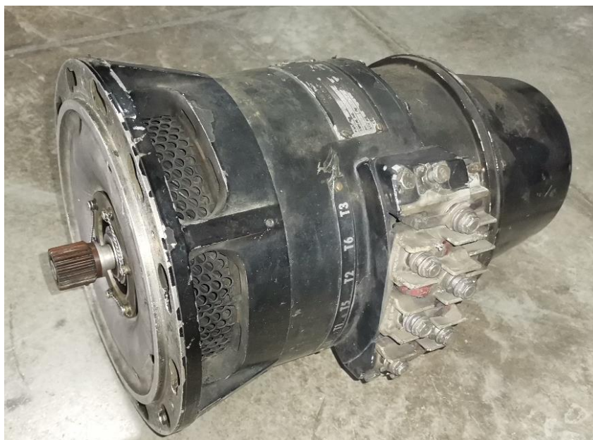
Εικόνα 2.34: Brushless γεννήτρια 40kVA αεροπλάνου.
