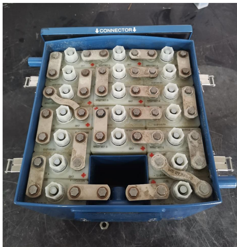
Εικόνα 2.60: Εσωτερικές διασυνδέσεις στοιχείων συσσωρευτή νικελίου – καδμίου.
