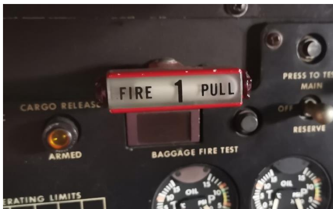
Εικόνα 8.4: Χειρολαβή έλξης ενεργοποίησης πυρόσβεσης.
