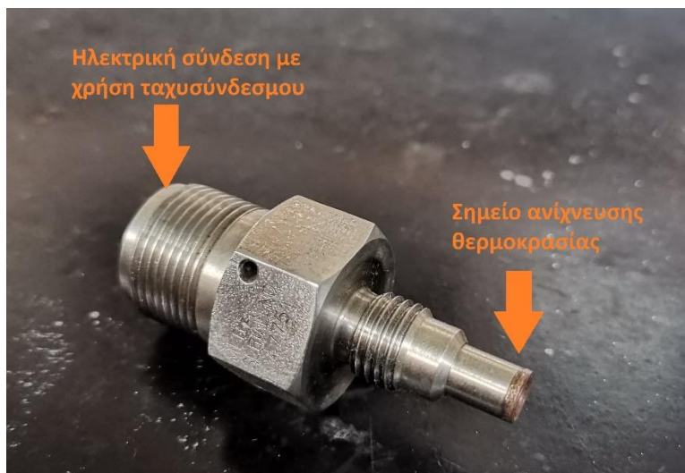
Εικόνα 7.16: Αισθητήρας θερμοκρασίας μεταβλητής αντίστασης (RTD).
