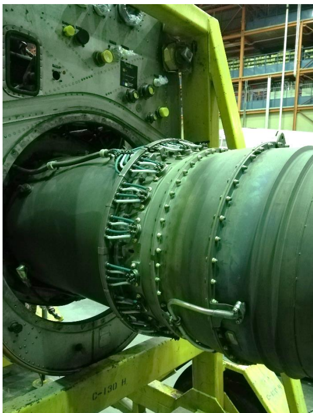
Εικόνα 7.14: Συστοιχία θερμοζευγών περιμετρικά του κινητήρα αεροπλάνου.
