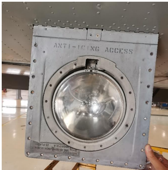
Εικόνα 6.13: Φως προσγείωσης σε αεροπλάνο (Landing light).
