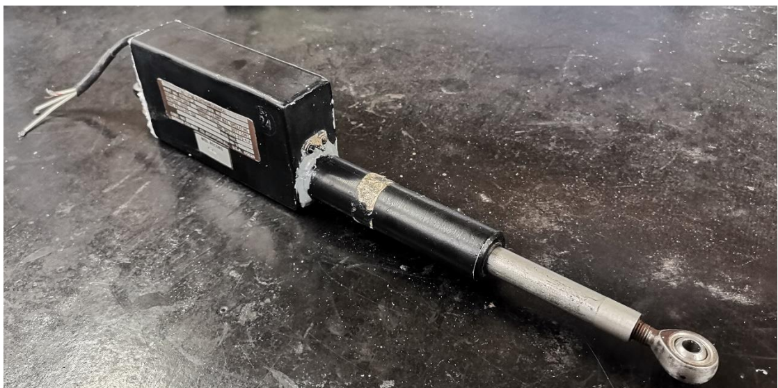
Εικόνα 4.41: Γραμμικός κινητήρας ενεργοποίησης (linear actuator).
