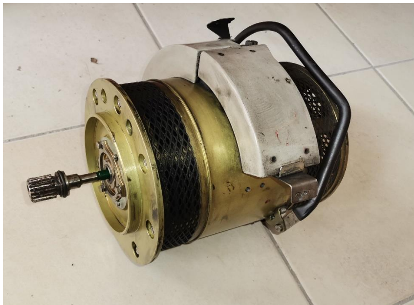
Εικόνα 2.33: Brushless γεννήτρια 20 kVA ελικοπτέρου.
