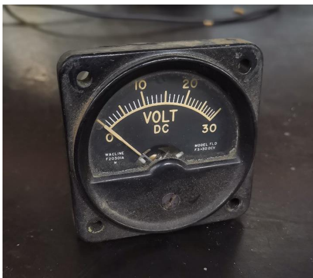
Εικόνα 7.7: Όργανο κινητού πηνίου σε χρήση βολτομέτρου
