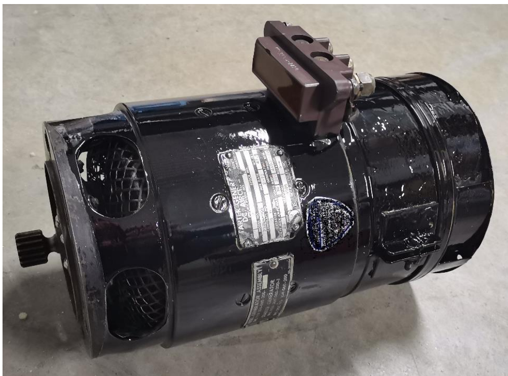
Εικόνα 2.55: Γεννήτρια ΣΡ παράλληλης διέγερσης 28V - 300A.
