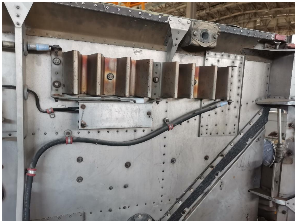
Εικόνα 5.17: Αντίσταση περιορισμού ρεύματος.
