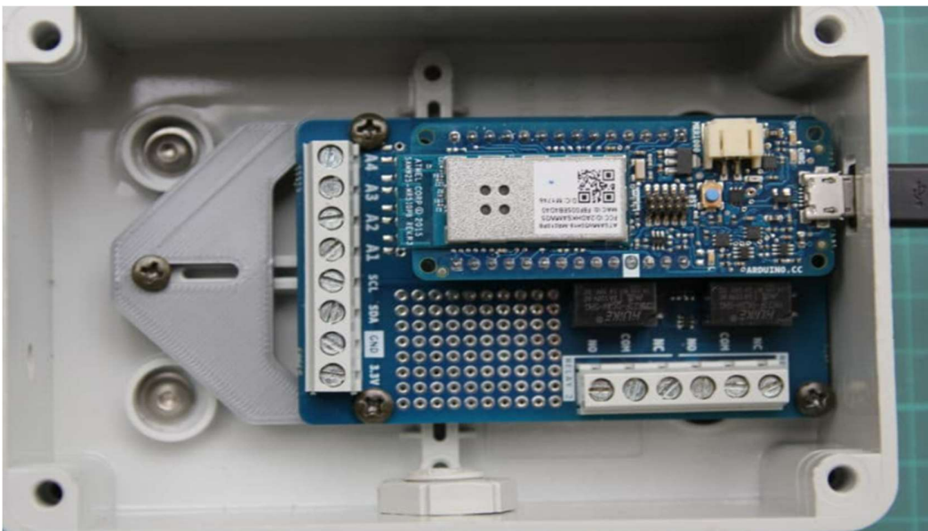
Εικόνα 5. Αυτόματο σύστημα ποτίσματος με Arduino Nano 33 IoT Cloud
