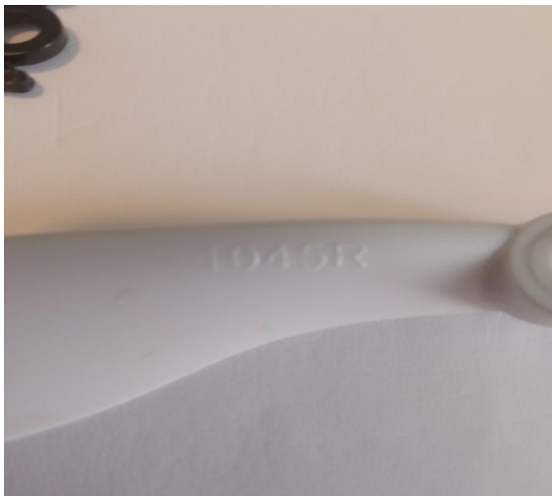
Εικόνα 10 Οι αριθμοί D(διάμετρος) και P(Βήμα) πάνω στην έλικα
