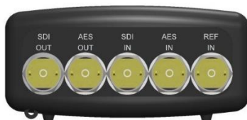
Εικόνα 38: BNC εξόδου της γεννήτριας σήματος
