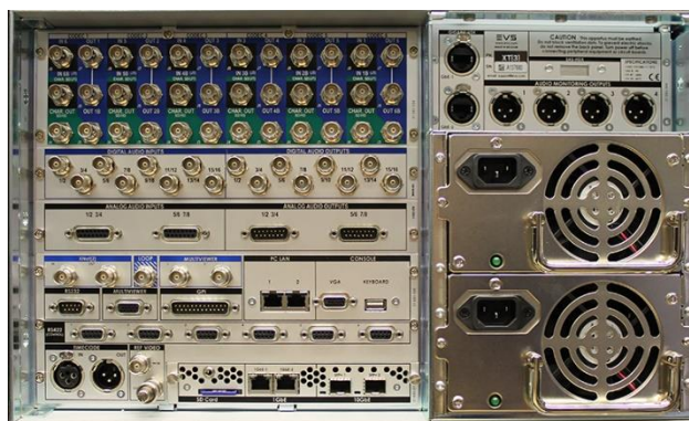
Εικόνα 18: Πίσω πλευρά σύνδεσης των καλωδίων στο σύστημα video replay
