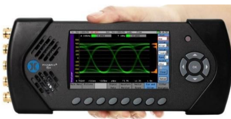
Εικόνα 30: Το eye display όπως εμφανίζεται στο φορητό όργανο Phabrics SxE
