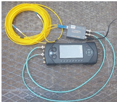
Εικόνα 81: Συνδεσμολογία μέτρησης οπτικής ίνας
