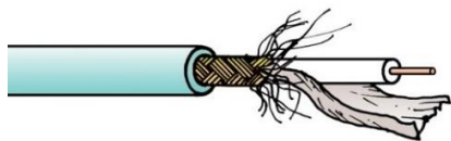
Εικόνα 21: Εσωτερική μορφή καλωδίου Canford SDV-LFH-E
