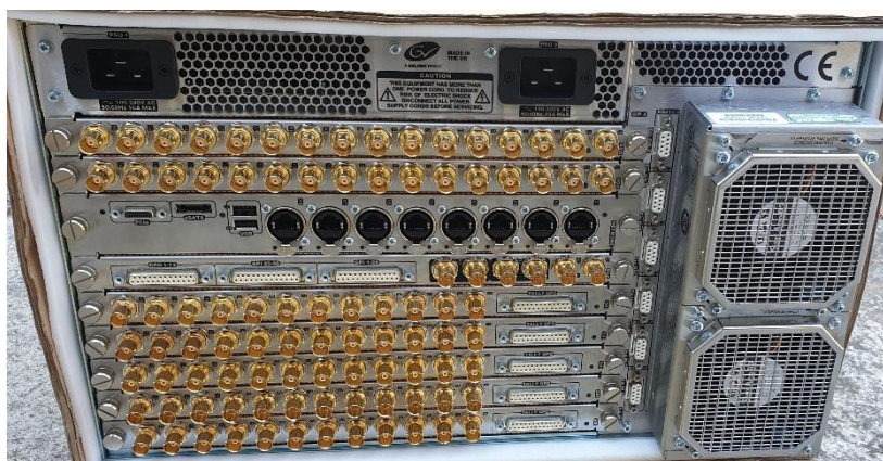
Εικόνα 16: Πίσω πλευρά σύνδεσης καλωδίων στο mainframe μιας κονσόλας εικόνας
