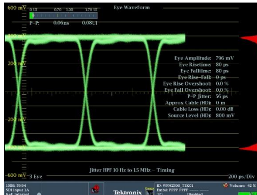
Εικόνα 34: Open eye σήματος
