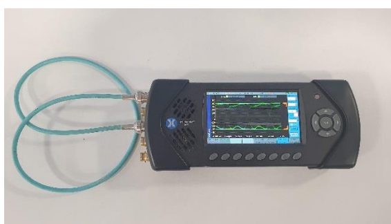
Εικόνα 53: Συνδεσμολογία μέτρησης ομοαξονικού καλωδίου 1m - B0
