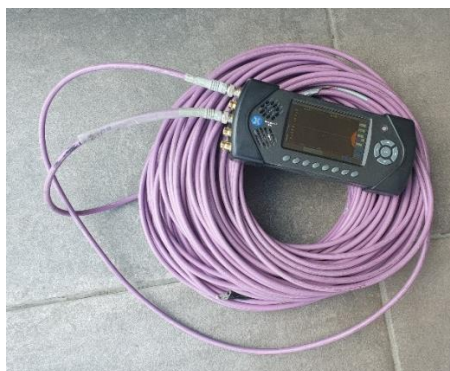
Εικόνα 55: Συνδεσμολογία μέτρησης ομοαξονικού καλωδίου
