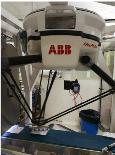
Εικόνα 7 delta ρομπότ τοποθετεί το προϊόν στα κουτιά και απορρίπτει τα λανθασμένα [16]
