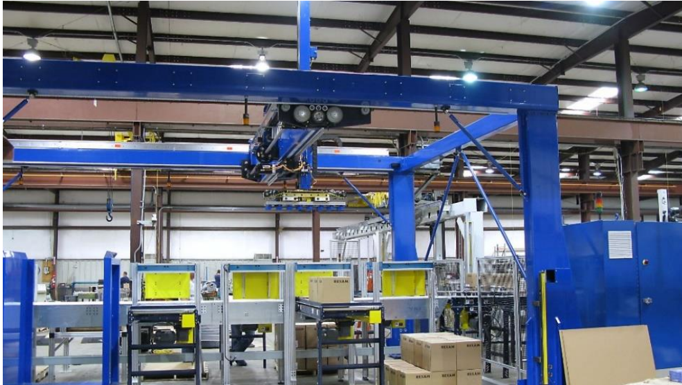
Εικόνα 5 gantry Ρομπότ μεταφέρει παλέτες και κούτες με φαρμακευτικά προϊόντα [13]
