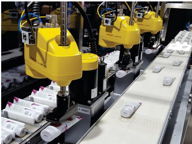
Εικόνα 4 Scara ρομπότ συσκευάζουν σωληνάρια σε μια γραμμή παραγωγής [10]
