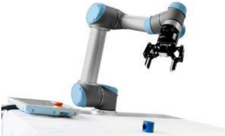
Εικόνα 12 Το ρομποτ ur3 με αρπαγή εκτελεί εφαρμογή pick and place [23]
