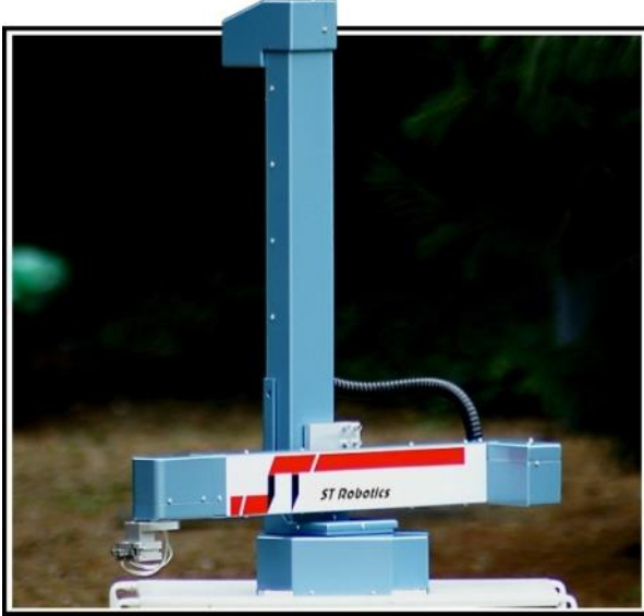
Εικόνα 6 R19E bench top 4-axis κυλινδρικού τύπου ρομπότ [15]
