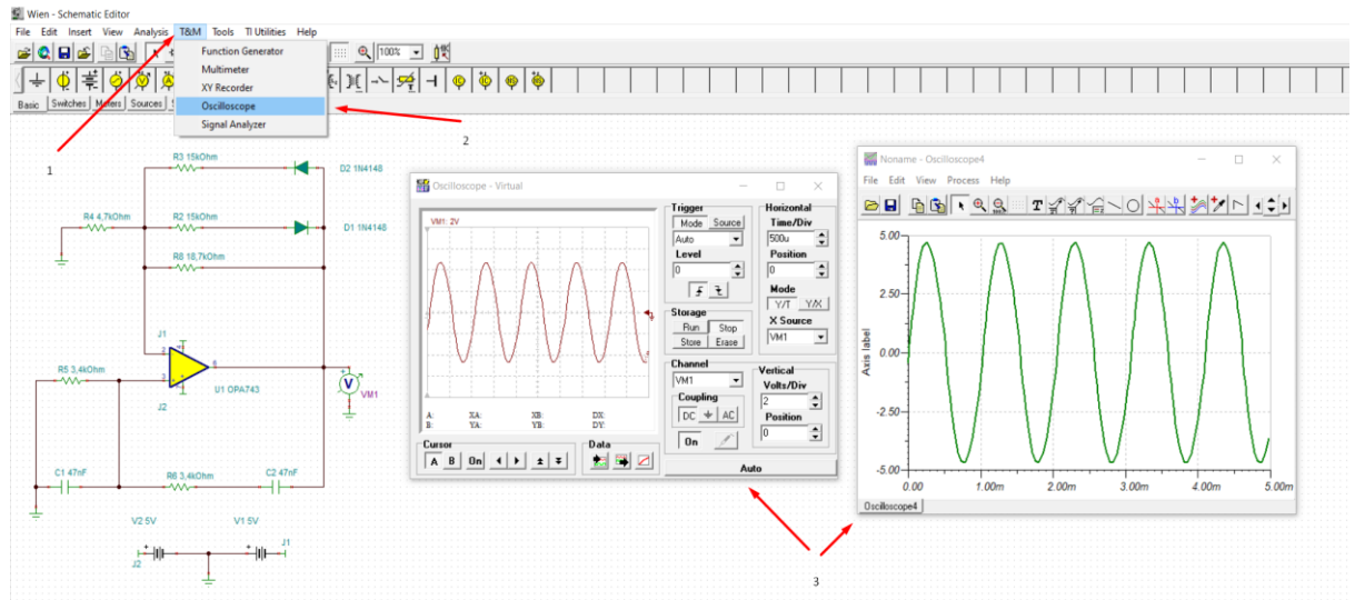
Εικόνα 3.8 – Προσομοίωση με εικονικό παλμογράφο
