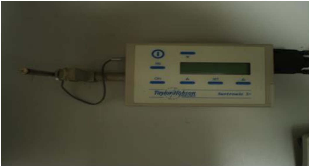
Εικόνα 2.5: Προφιλόμετρο γραφίδας (Taylor-Hobson), εργαστηρίου ΠΑΔΑ.
