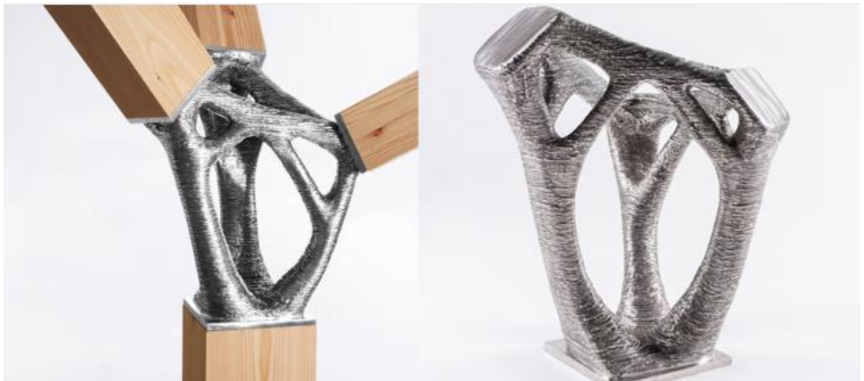
Εικόνα 3.12: Βελτιστοποιημένη κατασκευή μέσω τοπολογίας με τη μέθοδο WAAM από την εταιρία MX3D (Schwaar, 2022).
