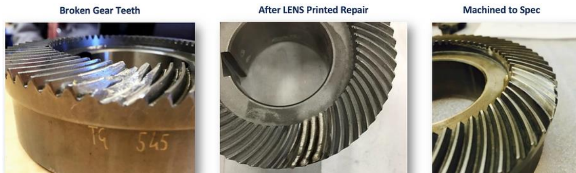
Εικόνα 2.25: Επιδιόρθωση οδοντωτού τροχού μέσω DED. (Select Additive, 2019)
