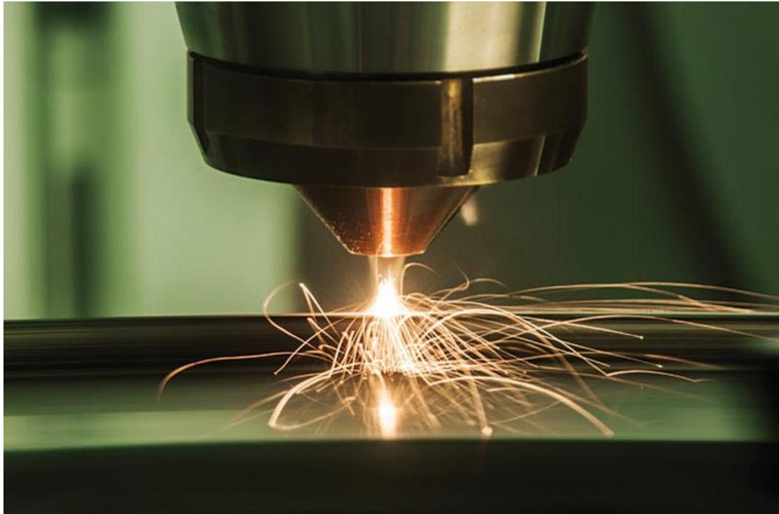
Εικόνα 2.24: Εκτύπωση με άμεση εναπόθεση ενέργειας. (Carlota, 2019)
