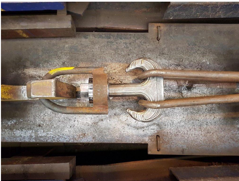
Εικόνα 3.10: Τρισδιάστατα εκτυπωμένος γάντζος WAAM της HUISMAN με ικανότητα ανύψωσης φορτίου έως 80.000 kg. (Singh & Khanna, 2021)
