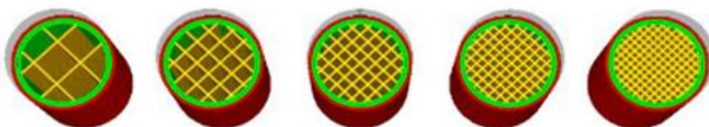
Εικόνα 2.5: Διαφορετικές πυκνότητες αντικειμένου (20-100%). (Pernet, et al., 2022)
