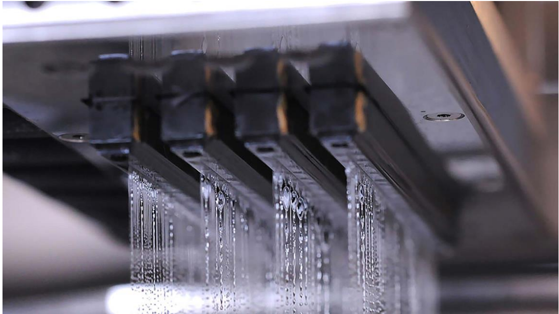
Εικόνα 2.16: Εκτόξευση συνδετικού υλικού. (AMFG, 2019)
