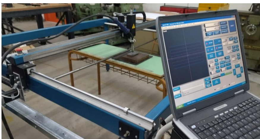
Σχήμα 6.2 Διάταξη CNC παντογράφου με την MIG
