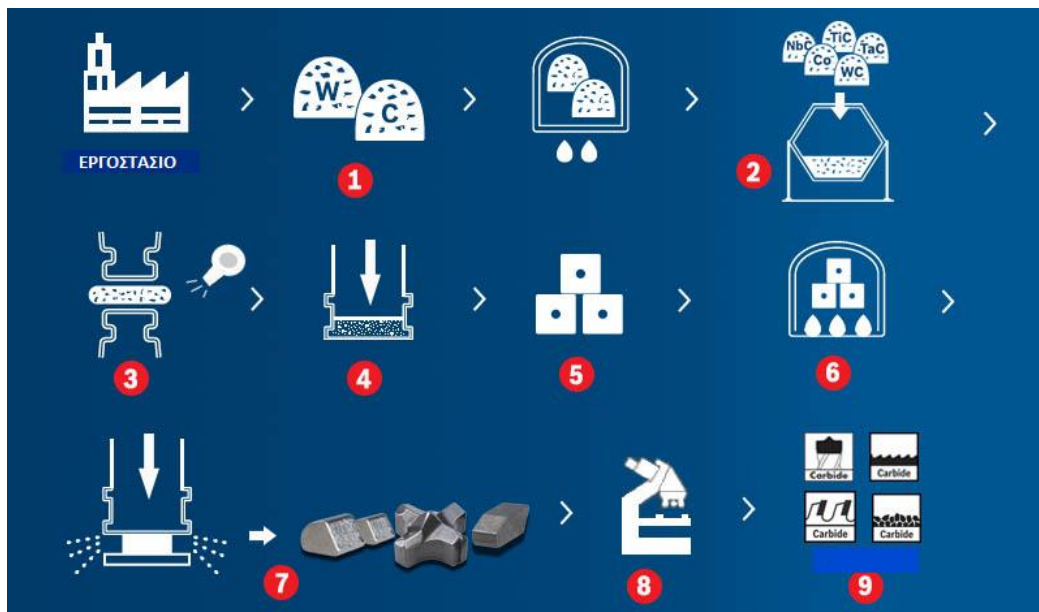
Σχήμα 2.6 Διαδικασία παραγωγής Καρβιδίου
