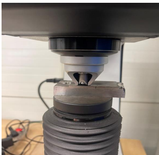
Σχήμα 6.8 Απεικόνιση διαδικασίας σκληρομέτρησης
