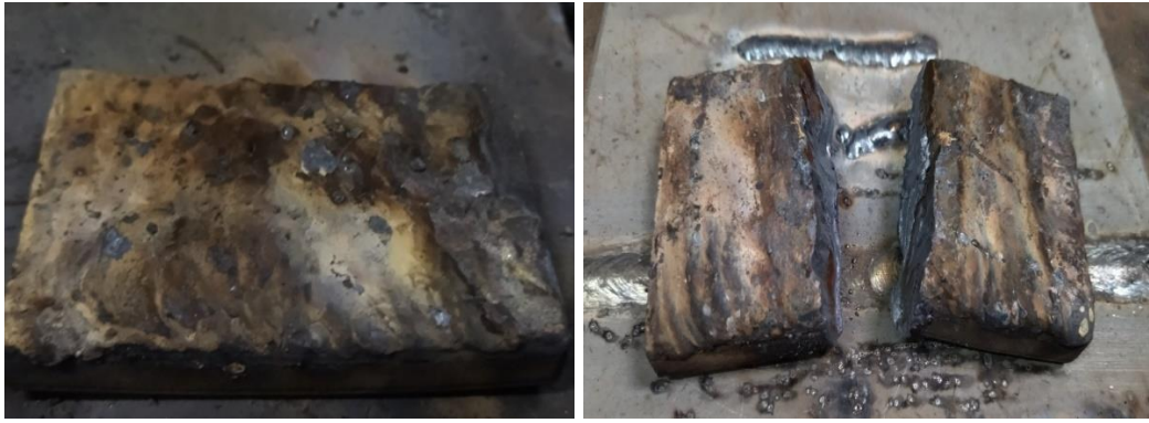
Σχήμα 6.3 Εικόνες πριν και μετά την κοπή με Laser
