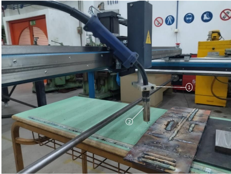
Σχήμα 5.2 Πειραματική διάταξη (προσαρμογή ηλεκτροσυγκόλλησης MIG στον παντογράφο CNC)
