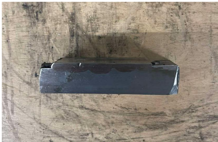
Σχήμα 6.5 Πλάγια όψη του δοκιμίου μετά την χημική προσβολή
