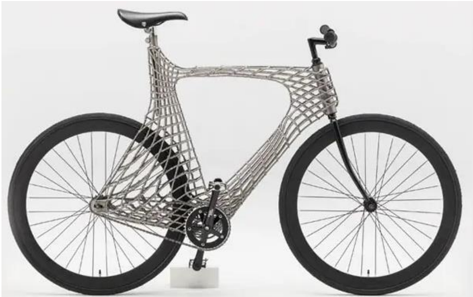
Εικόνα 18 Κατασκευή ποδηλάτου με WAAM (Tuvie)
