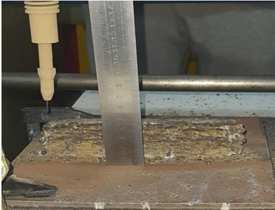
Εικόνα 33 Μέτρηση ύψους κατά την δημιουργία ( Z = 45 \text{ mm} )
