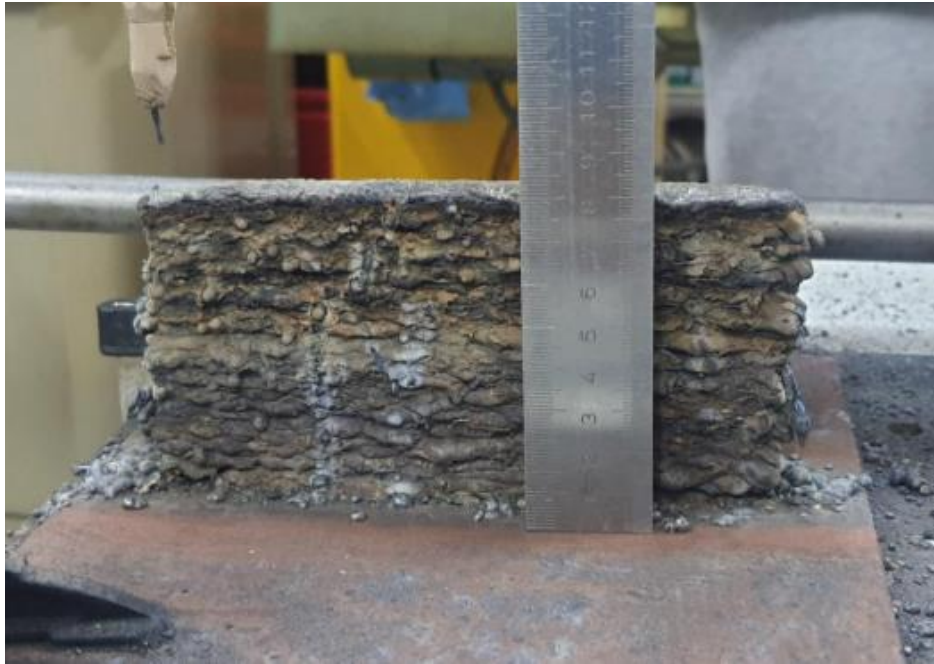
Εικόνα 36 Μέτρηση ύψους του τελικού αντικειμένου ( Z = 80 \text{ mm} )
