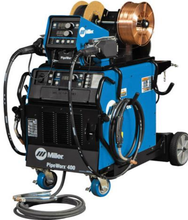
Εικόνα 20 Μηχανή συγκόλλησης τύπου GMAW (Θεοδόσιος Σκάρος, 2022)
