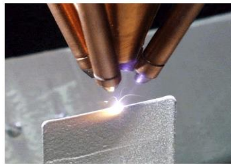
Εικόνα 5 Διάγραμμα της τεχνολογίας LENS και η εκτυπωτική διαδικασία της τεχνολογίας LENS (Κυριακόπουλος Κυριάκος, 2016)
