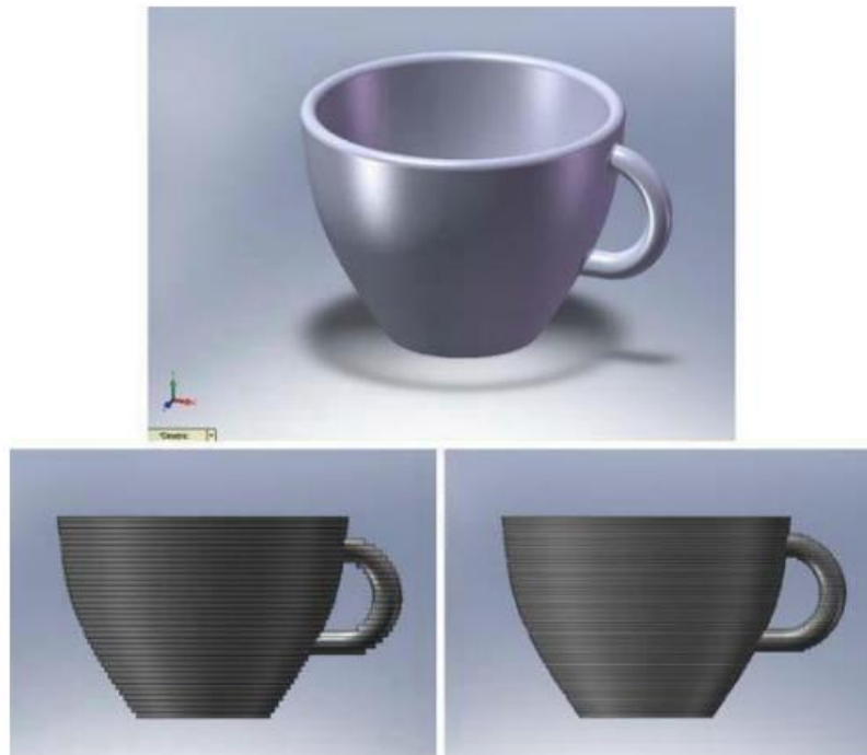
Εικόνα 1 Γεωμετρικό Μοντέλο CAD ενός φλυτζανιού με εικόνες που αποτυπώνουν το αποτέλεσμα χρήσης διαφορετικών παχών (Κωστάκης Ιωάννης, 2017)
