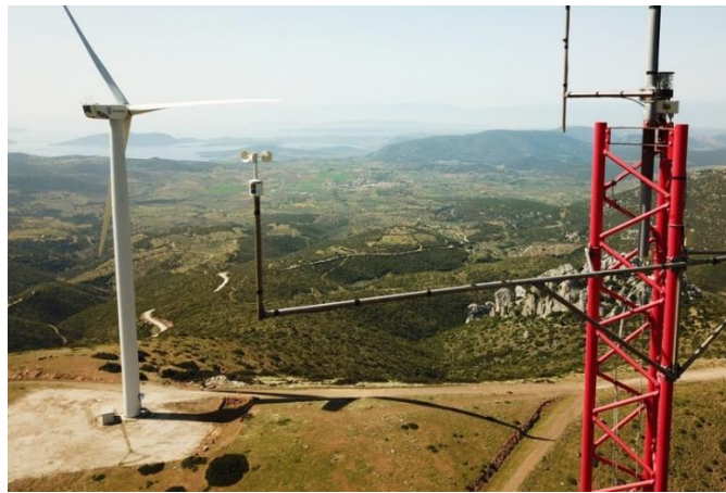
Εικόνα 10: Μέτρηση αιολικού δυναμικού με ιστό. Πηγη: https://www.windengineering.gr/el/yphresies/dokimes-kai-metrhseis/metrhsh-aiolikov-dynamikou
