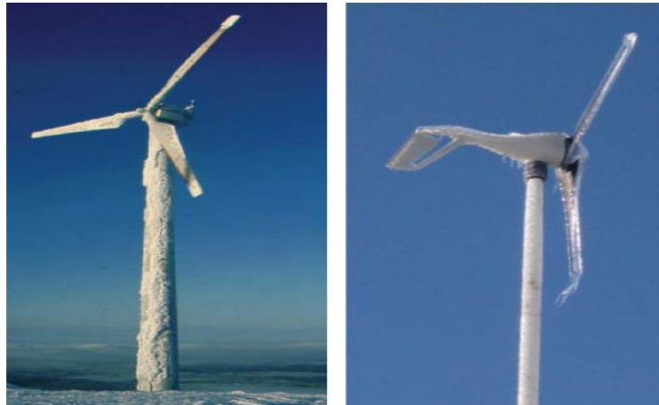
Εικόνα 26: Παρουσία πάγου πάνω σε Α/Γ. Πηγή: https://medium.com/@lugoafonso/icing-on-wind-turbines-blades-c2c2364b94e7
