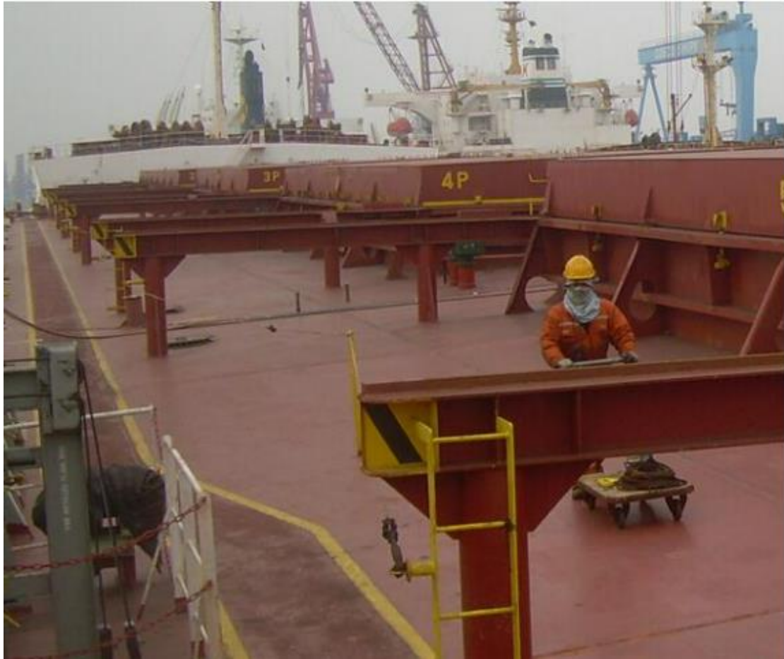
(Εικόνα 2.8: Depiction of panel's transverse ramps / Απεικόνιση των εγκάρσιων ραμπών των πάνελ - http://www.marine-servicesolution.com/ )
