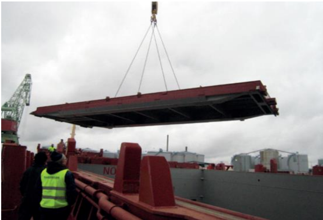
(Εικόνα 2.9: Depiction of a Lift – Away Hatch Cover / Απεικόνιση απομάκρυνσης ενός καλύμματος ανύψωσης - https://www.londonpandi.com/ )
