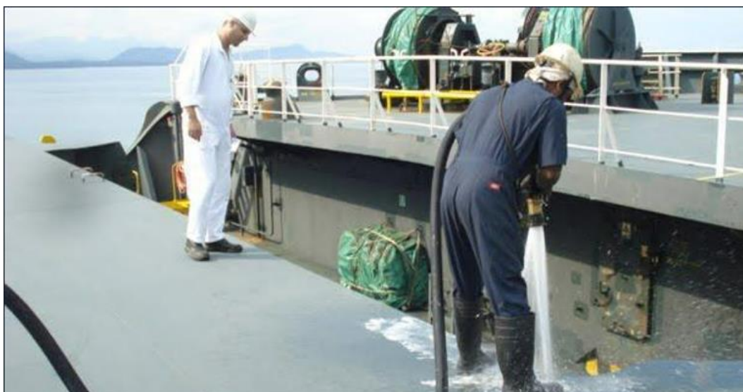
(Εικόνα 3.1: Water hose leak detection test/inspection - Έλεγχος / Επιθεώρηση στεγανότητας καλύμματος με χρήση μάνικας υψηλής πίεσης – www.standard-club.com )
