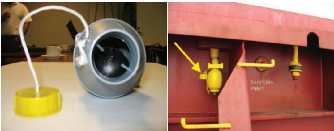
(Εικόνα 3.13: Βαλβίδα αποστράγγισης με μπάλα στο εσωτερικό (αριστερά) & Βαλβίδα αποστράγγισης με σπειροειδές καπάκι (δεξιά) -
