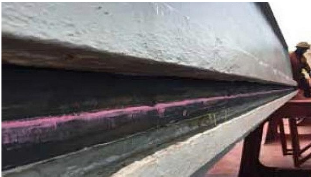
(Εικόνα 3.3: Chalk test / Έλεγχος με χρήση κιμωλίας – www.standard-club.com )
