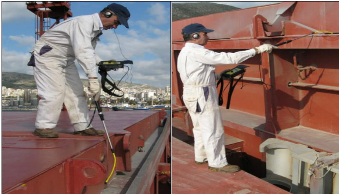
(Εικόνα 3.2: Ultrasonic leak detection test / Έλεγχος στεγανότητας με χρήση υπερήχων – www.overseasmaritime.com )
