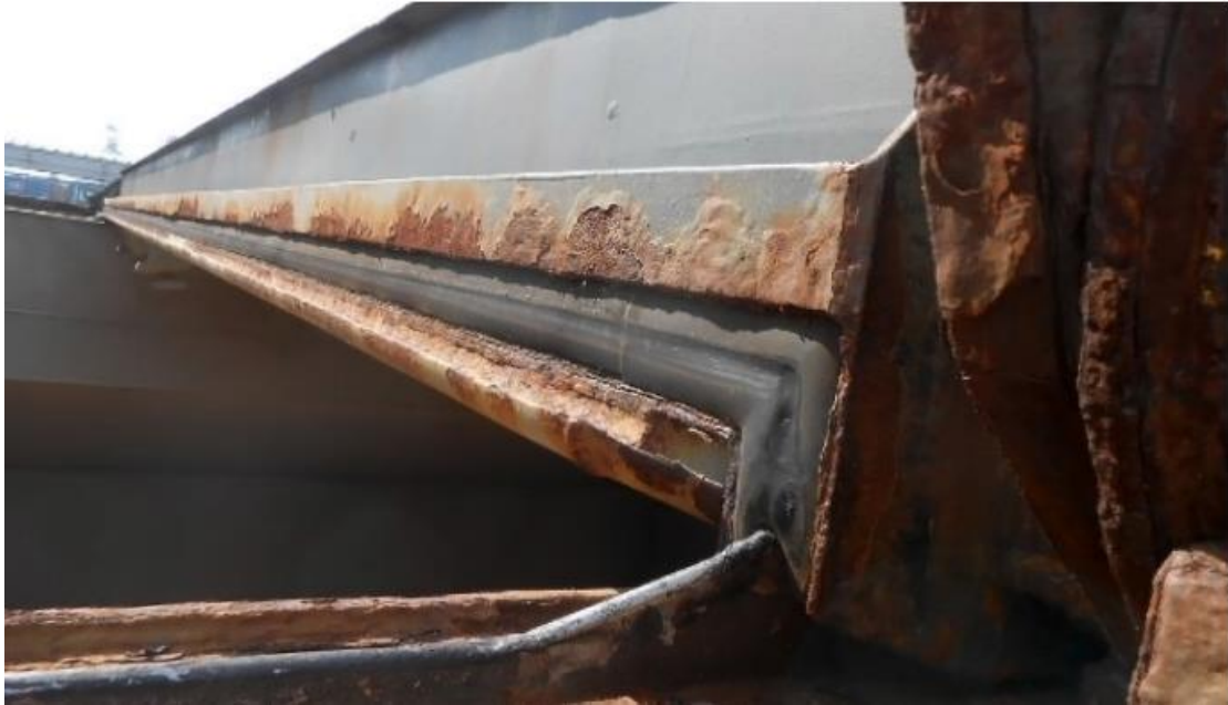
(Εικόνα 3.4: Maintenance of hatch cross joints / Συντήρηση των εγκάρσιων συνδέσμων - www.standard-club.com )
