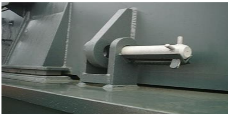
(Εικόνα 3.16: Μηχανισμός συγκράτησης τύπου jumping stopper - http://shipsbusiness.com/hatchcover.html )
