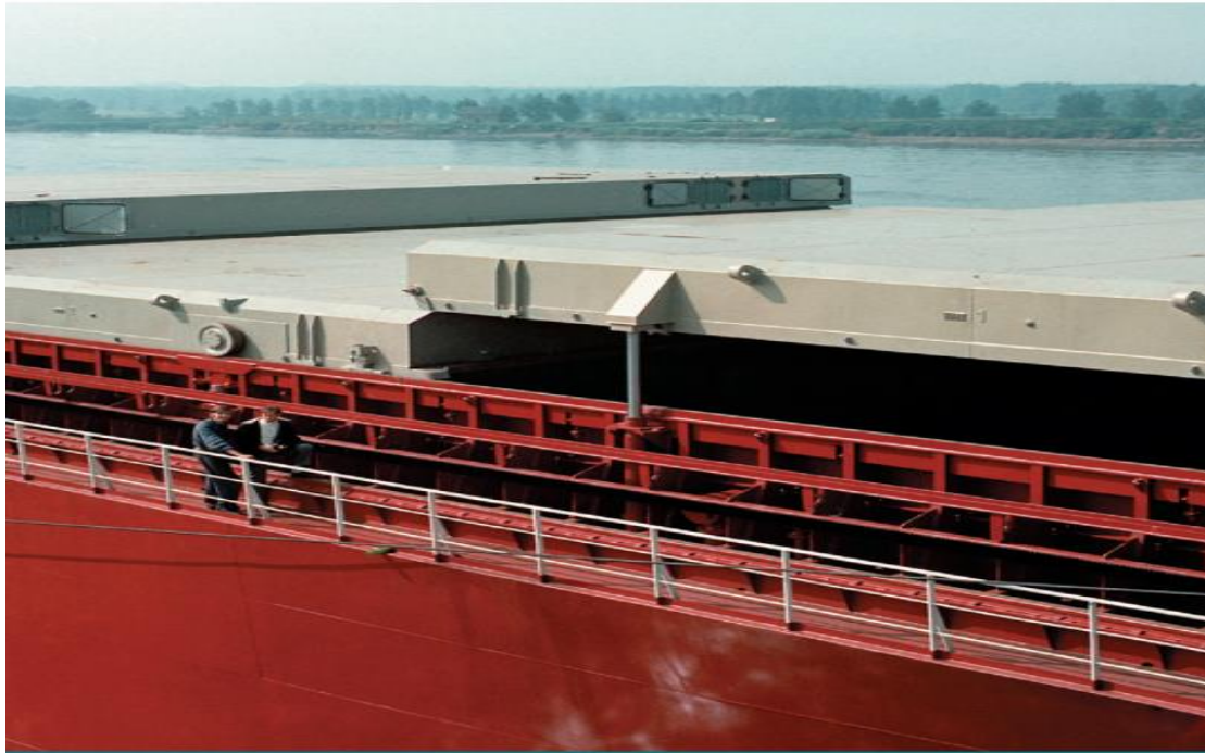
(Εικόνα 2.4: Piggy-Back Hatch Cover / Καλύμματα Στομίου Κύτους Piggy-Back - https://www.macgregor.com/ )
