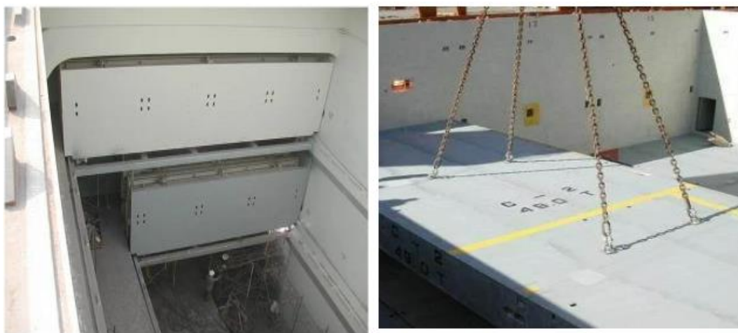
(Εικόνα 2.10: Folding Tweendeck Panels / Αναδιπλούμενα Tweendeck Πάνελ (αριστερά) – Lift -Away Tweendeck Panel / Αποσπώμενα Tweendeck Πάνελ (δεξιά) -
