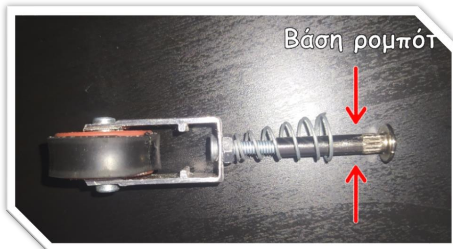
Εικόνα 52: Ο τρόπος συναρμολόγησης του αμορτισέρ
