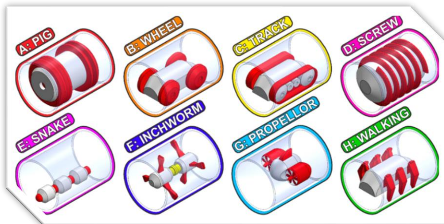
Εικόνα 3: Τα οκτώ κύρια στοιχεία της ρομποτικής κίνησης εντός σωλήνα (Α–Η). (Πηγή: [18])
