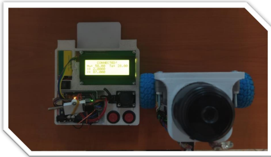
Εικόνα 77: Ζωντανή αναμετάδοση προσανατολισμού άξονα X και Y σε θέση (0/90°)
