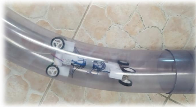
Εικόνα 41: Πλοήγησης ρομπότ σχεδίου 3 σε καμπύλη
