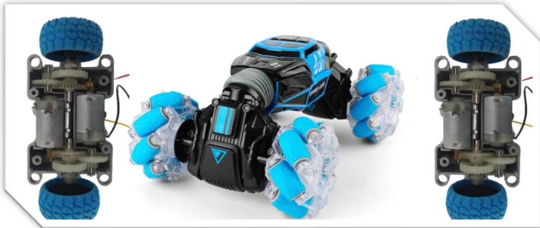
Εικόνα 45: Τηλεκατευθυνόμενο όχημα - μοτέρ με καπάκι και χωρίς
