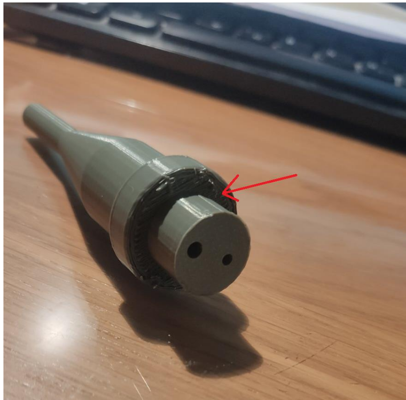
Εικόνα 4.1. Η επιφάνεια στήριξης των supports.
