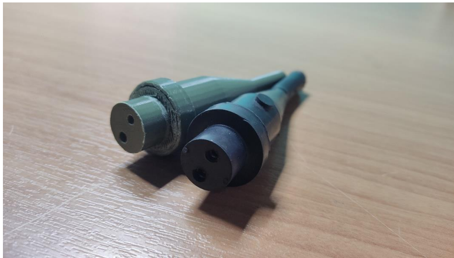
Εικόνα 3.13. Σύγκριση εκτυπωμένου και πρωτότυπου βύσματος.
