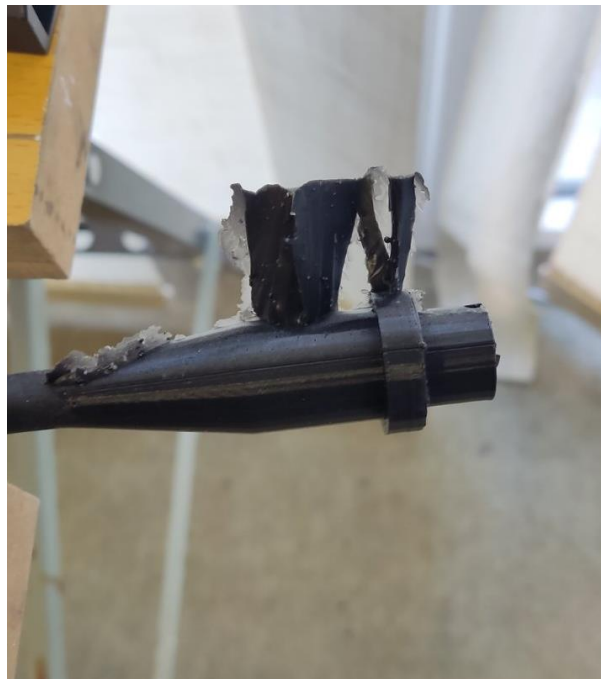
Εικόνα 3.17. Περιττό υλικό λόγω χύτευσης.
