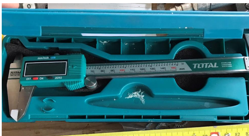
Εικόνα 16: Το ιδιωτικό ψηφιακό παχύμετρο.
