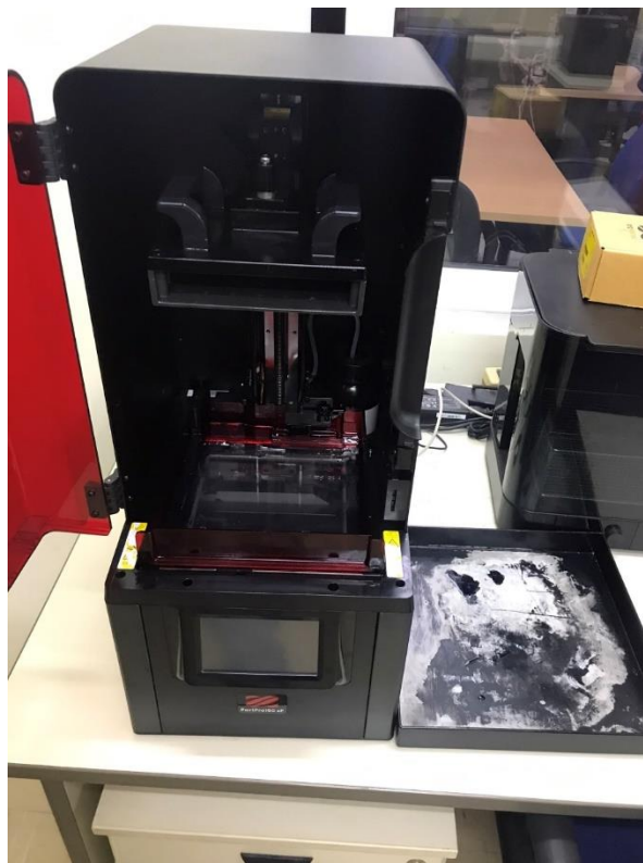
Εικόνα 5: Το εσωτερικό του 3D εκτυπωτή. Χαμηλά βρίσκεται το δοχείο όπου εισέρχεται η αναγκαία ποσότητα από το μπουκάλι της ρητίνης (δεξιά στο βάθος του εκτυπωτή). Ψηλά βρίσκεται η πλάκα εκτύπωσης όπου δημιουργούνται τα δοκίμια.
