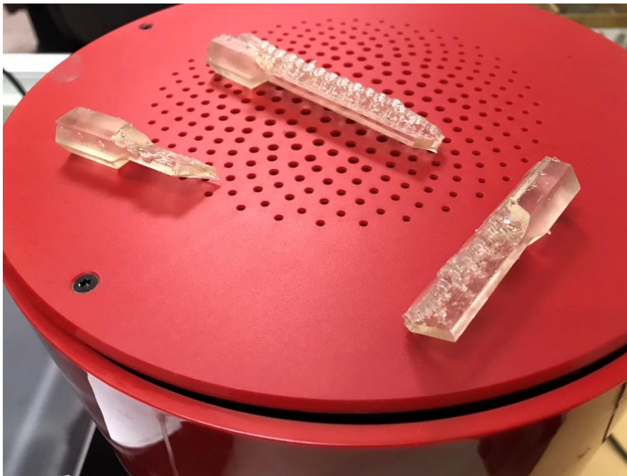
Εικόνα 34: Αποτυχημένη δοκιμαστική εκτύπωση.
