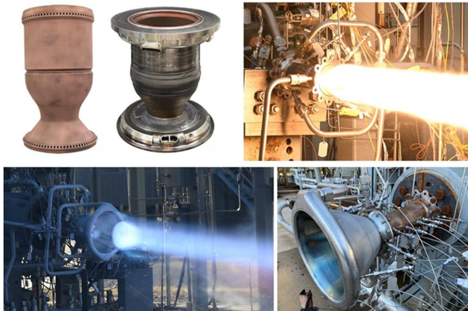
Εικόνα 1: Παραδείγματα συγκροτημάτων θαλάμου ώσης πλήρως κατασκευασμένα με AM που δοκιμάστηκαν σε υψηλές θερμοκρασίες στη NASA (Πηγή: NASA).
