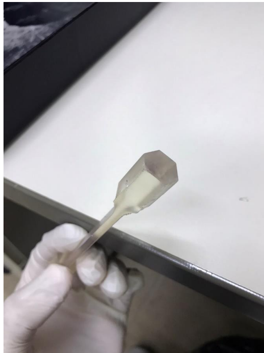
Εικόνα 11: Δοκίμιο εκτυπωμένο κατά τον άξονα y .
