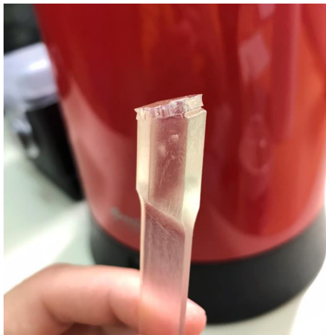
Εικόνα 15: Δοκίμιο εκτυπωμένο κατά τον άξονα z.
