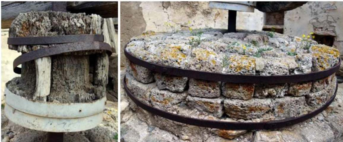
Εικόνα 22 , Η ανέμη με τα πεντάραβδα (αριστερά) και το σύστημα των μυλόπετρων (δεξιά).
