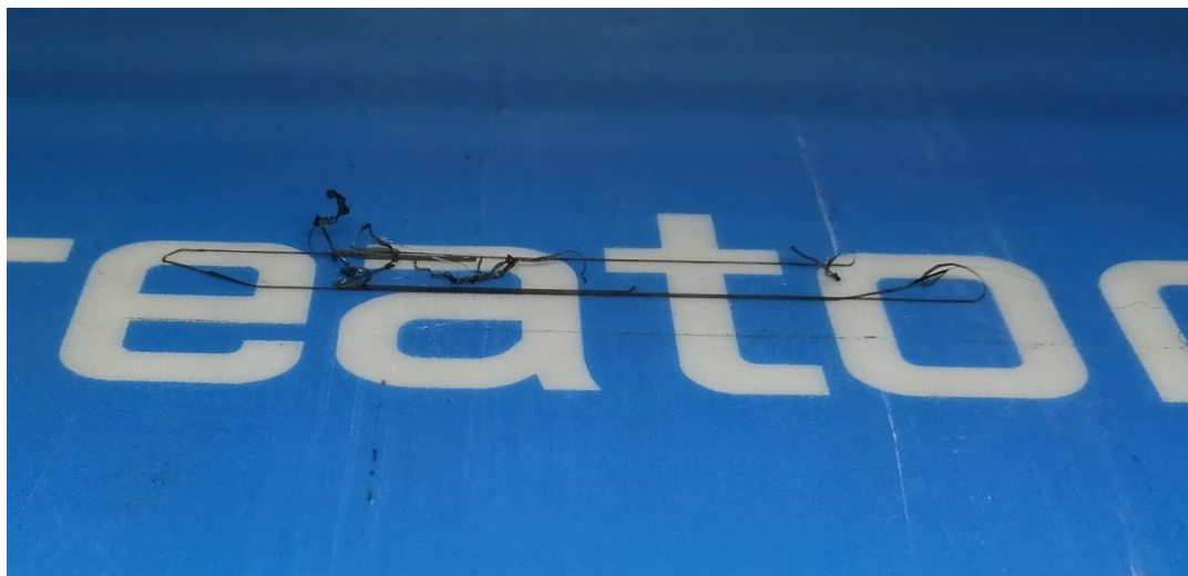
Εικόνα 24. Αποτυχούσα εκτύπωση λόγω υψηλής ταχύτητας εκτύπωσης
