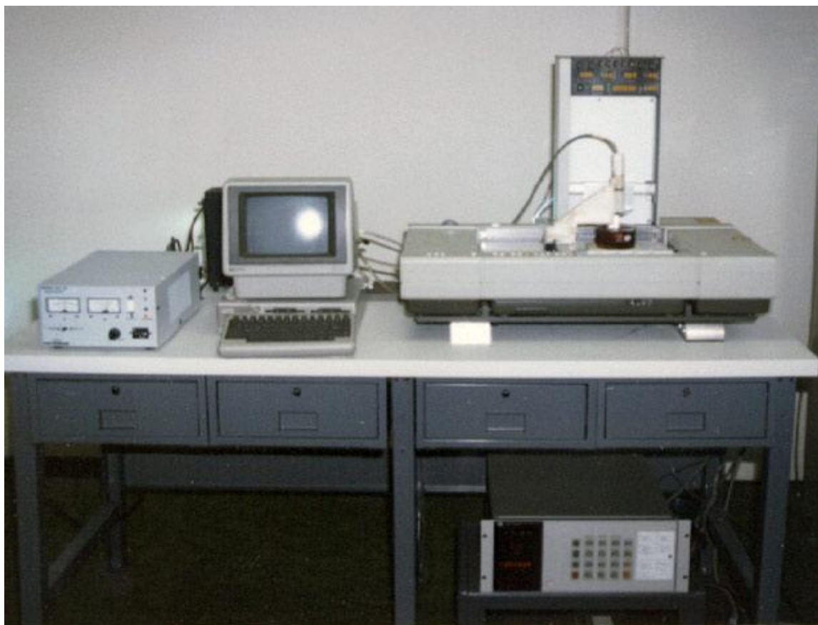
Εικόνα 3. Η πρώτη μηχανή προσθετικής εκτύπωσης
