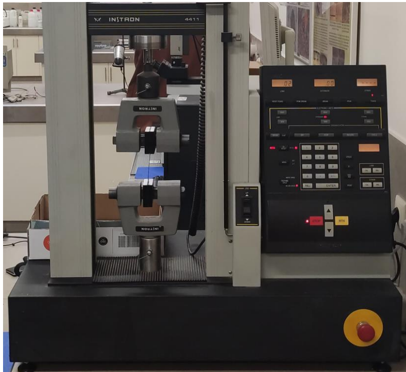
Εικόνα 20. Στιγμιότυπο κατά την διάρκεια εφελκυσμού ενός δοκιμίου
