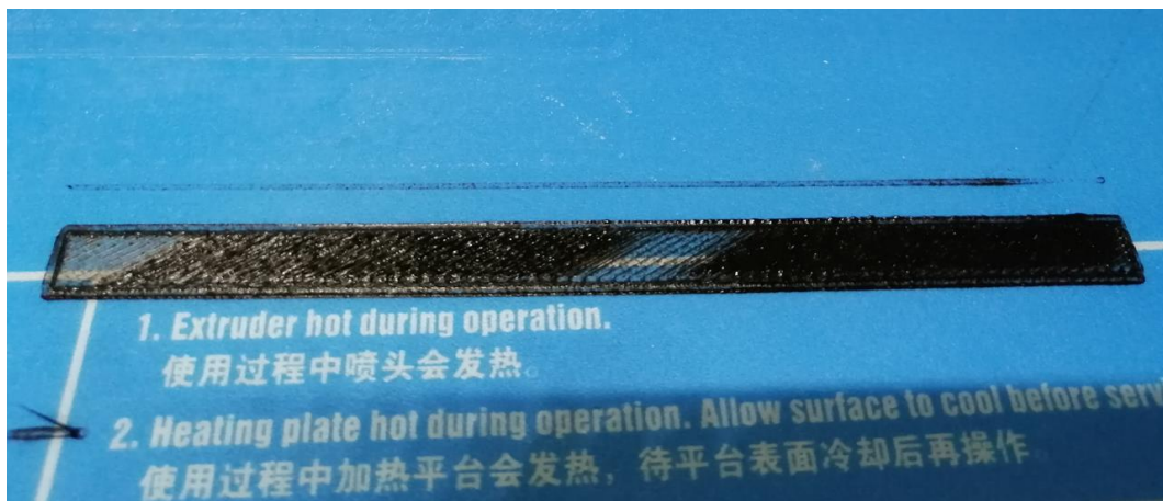
Εικόνα 26. Αποτυχούσα εκτύπωση λόγω βλάβης του nozzle
