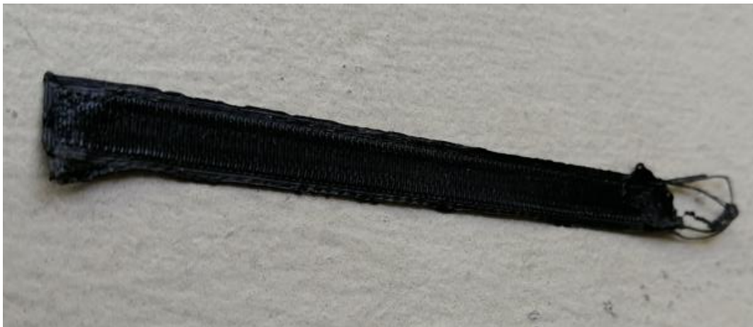
Εικόνα 25. Αποτυχούσα εκτύπωση σε πολλά σημεία λόγω πολλαπλών παραμέτρων
