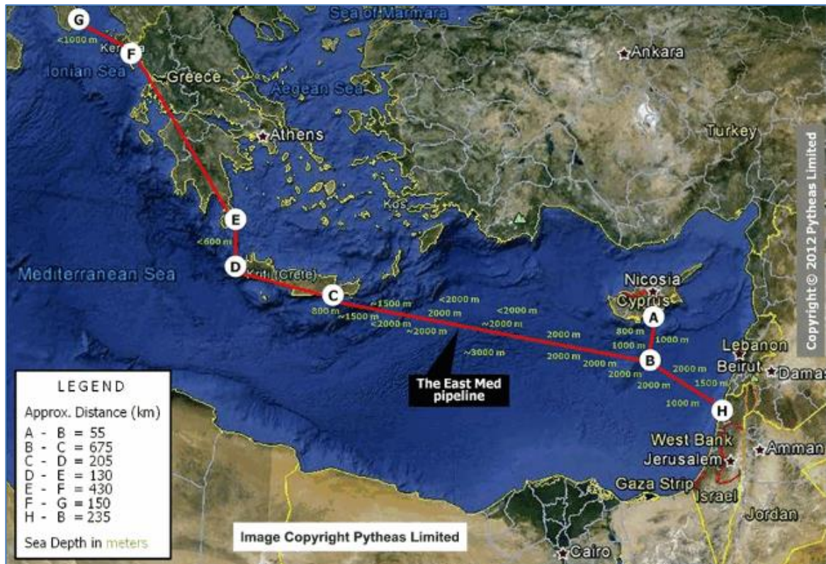
Εικόνα 15: Ο αγωγός «EastMed» μήκους 1900km (700km στην ξηρά, 1200 offshore) στην Ελλάδα, με δυναμικό έως 20bcm/έτος (αρχικά 10bcm/έτος), με σταθμούς συμπίεσης σε Κύπρο και Κρήτη. Προβλέπεται να κοστίσει 6 δις. ευρώ, θα είναι ο μεγαλύτερος μήκους υποθαλάσσιος αγωγός στον κόσμο. (DEPA, Vassallo, 2013).
