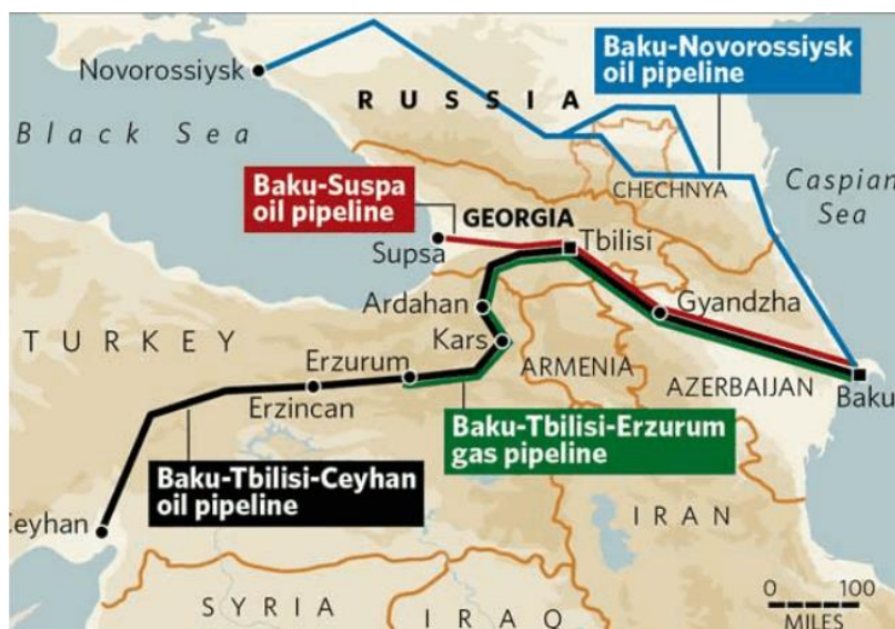
Εικόνα 21. Παράδειγμα όδευσης διασυνοριακού αγωγού πετρελαίου Baku-Tbilisi-Ceyhan που δεν ακολουθεί την συντομότερη και οικονομικότερη διαδρομή ( http://www.azerb.com/az-btc.html?i=1 ).
