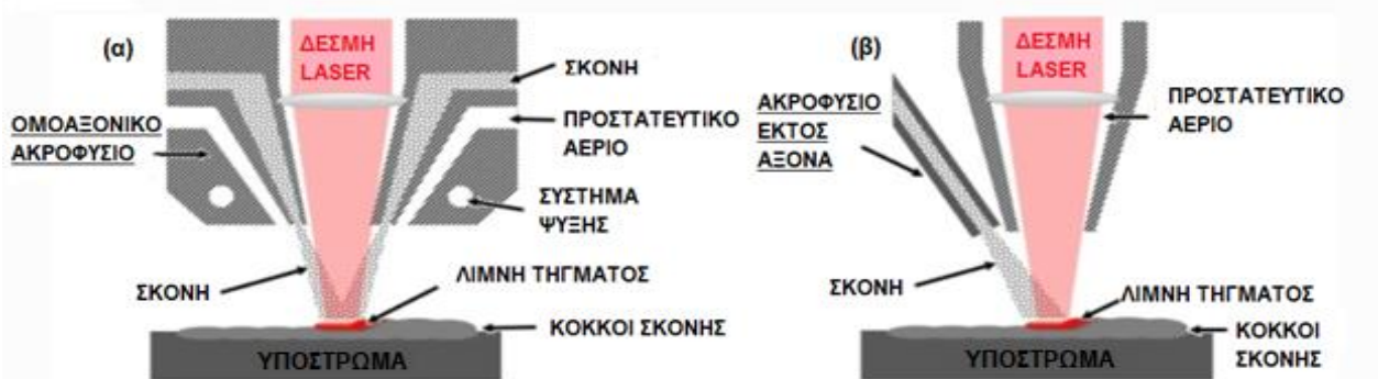
Εικόνα 20: Αρχή διαδικασίας κατευθυνόμενης ενεργειακής δέσμης DED (α) με ακροφύσιο ενσωματωμένο στον άξονα, (β) με ακροφύσιο αποσπώμενο από τον άξονα (Ahn, 2021).
