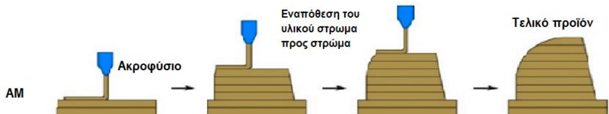
Εικόνα 8: Διαδικασία 3D εκτύπωσης, εναπόθεση του υλικού από το ακροφύσιο στρώμα προς στρώμα (Gaikwad, 2022).
