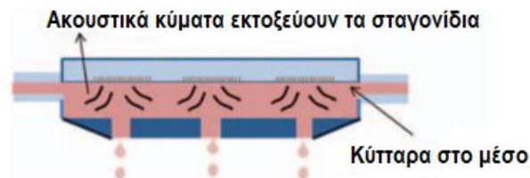
Εικόνα 17: Εκτύπωση μέσω ακουστικών κυμάτων (Zhang, Fisher and Leong, 2022).
