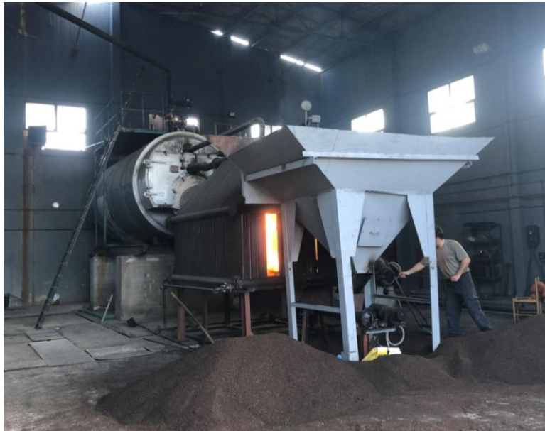
Εικόνα 4: Συσκευές παραγωγής ατμού προς δημιουργία κενού εντός του εκχυλιστήρα σε πυρηνελαιουργείο της Ρόδου.
