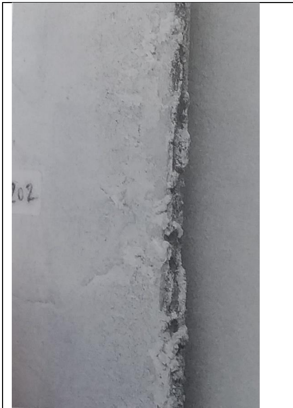
Εικόνα 2. Οπίσθια όψη από επικασσιτερωμένο κεραμικό πλακίδιο (ίν. 5202) με εξανθήσεις άλατος. Πηγή: Halsberghe et al. 2005 p. 132.
