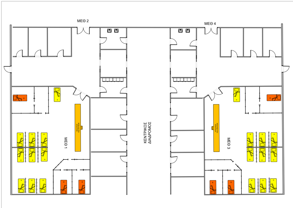
Εικόνα 4. Κάτοψη των ΜΕΘ που κατασκευάστηκαν στο Νοσοκομείο.
