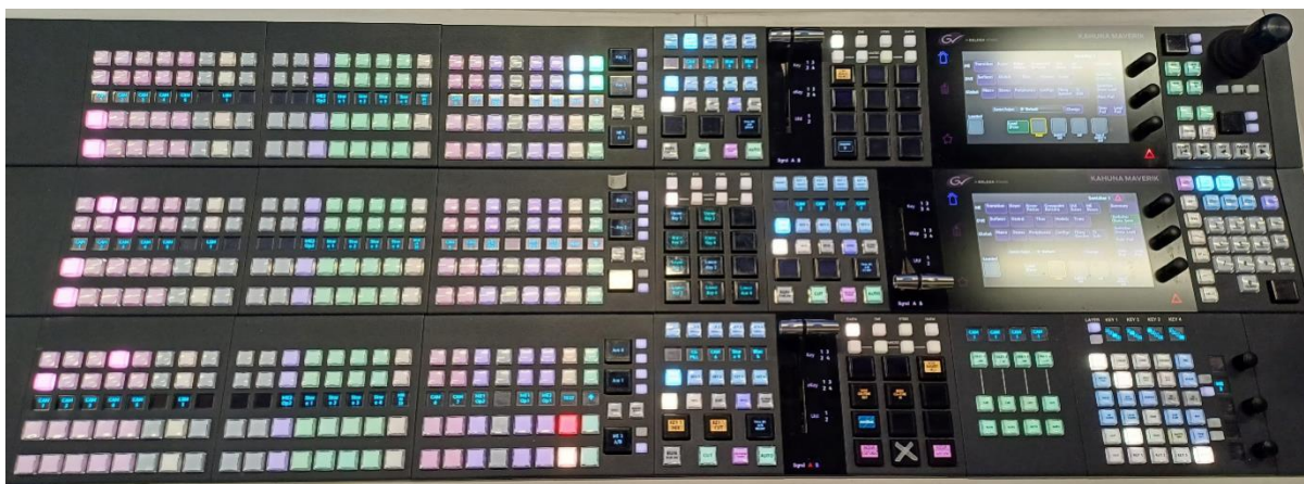
Εικόνα 15: Πάνελ Κονσόλα μίξης Kahuna 9600
