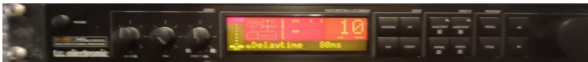
Εικόνα 115: Μονάδα καθυστέρησης ήχου με delay time 80ms
