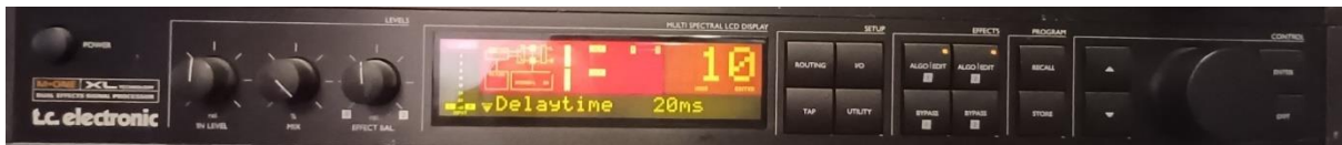
Εικόνα 94: Μονάδα καθυστέρησης ήχου με delay time 20ms
