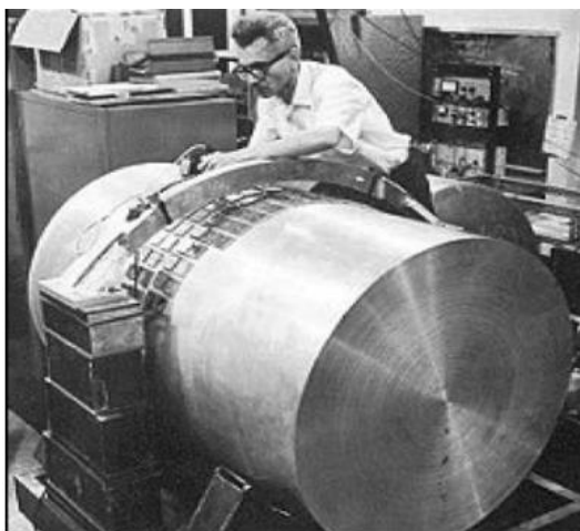
Εικόνα 3.40 Φωτογραφία του Τζότζεφ Βέμπερ με την ευρηματική του κατασκευή, τον ραβδόμορφο ανιχνευτή βαρυτικών κυμάτων (Ciufolini & Matzner, 2010).
