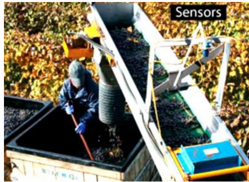
Εικόνα 8 : Σύστημα μέτρησης ροής σταφυλιών με εκτίμηση του όγκου τους με τη χρήση υπερήχων.
