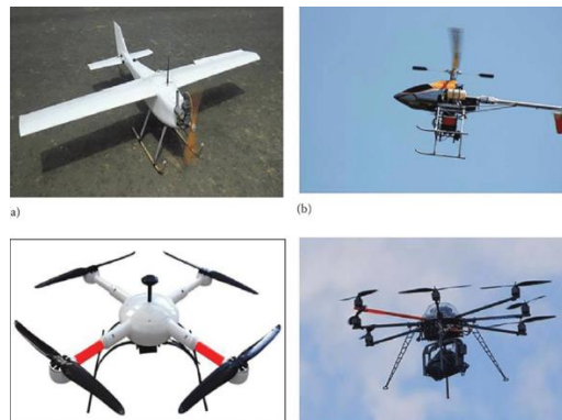
Εικόνα 4 : Η εικόνα δείχνει 4 διαφορετικούς τύπους UAV α) αεροσκάφος με ενσωματωμένα φτερά, b) ελικόπτερο, c) με 4 έλικες και d) 8 έλικες (πηγή : https://www.researchgate.net )
