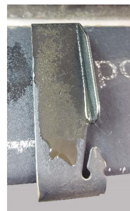
Εικόνα 122: Επιφάνεια κρακελέ κατά την διάρκεια του καθαρισμού (φορέας, οδηγός άκρης χαρτιού)
