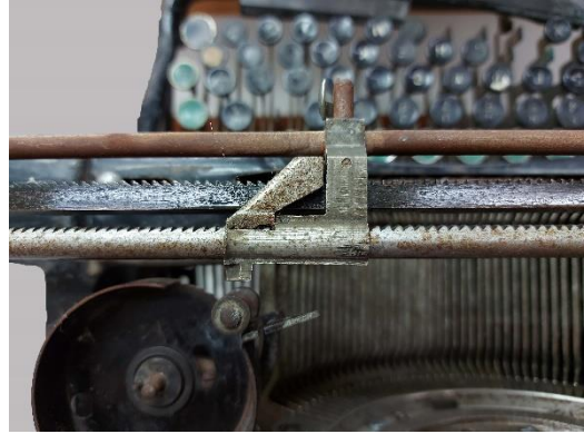
Εικόνα 145: Επιμεταλλωμένο εξάρτημα (κουδούνι) πριν τον καθαρισμό με EDTA
