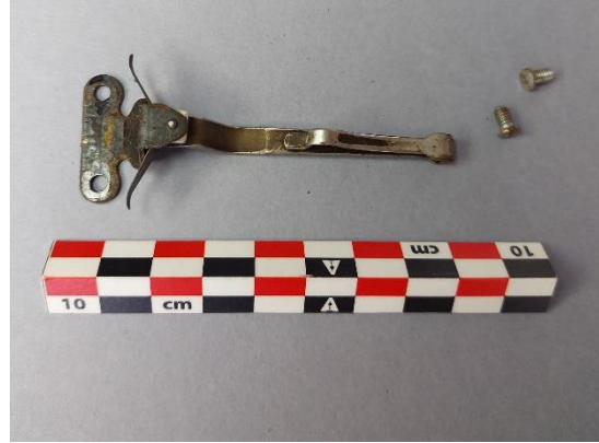
Εικόνα 98: Εξάρτημα που αφαιρέθηκε από τον φορέα της γραφομηχανής (δίκτης σημείου εκτύπωσης, κάτω όψη)
