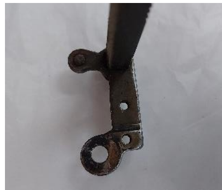
Εικόνα 138: Εξάρτημα του φορέα πριν τον χημικό μηχανικό καθαρισμό με EDTA 10% και σύρμα
