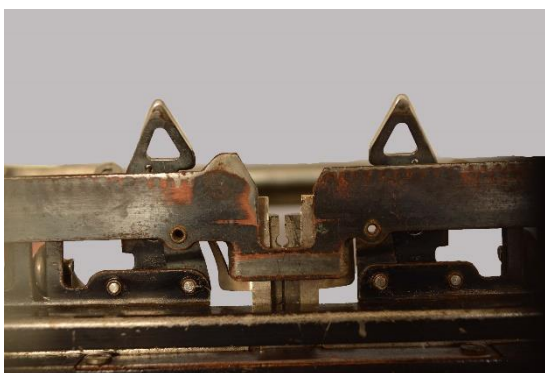
Εικόνα 207: Πάνω όψη γραφομηχανής μετά τον καθαρισμό (οδηγοί γραμμών τύπων, κορδέλας)
