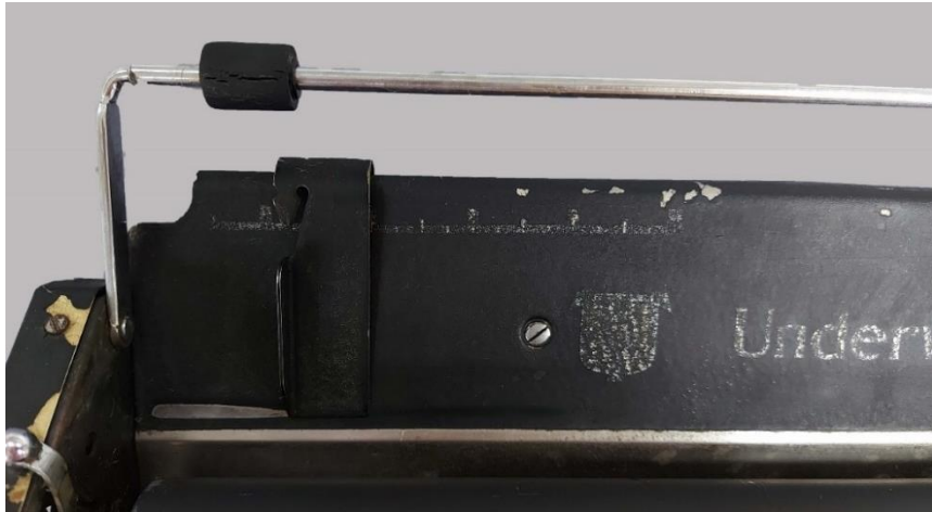
Εικόνα 238: Μπροστινή όψη του φορέα της γραφομηχανής μετά τον καθαρισμό (αριστερή πλευρά)
