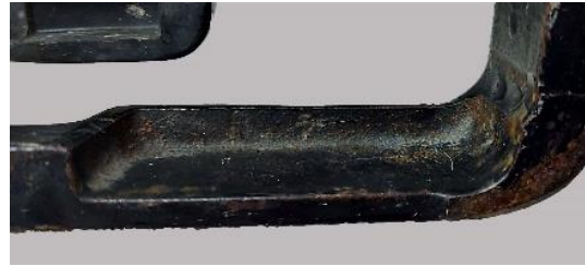
Εικόνα 127: Πριν την εφαρμογή NaOH 1% στην βαφή λείας επιφάνειας (κάτω όψη, δεξιά)
