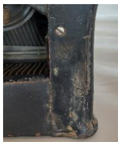
Εικόνα 112: Αποτέλεσμα στην βαφή μετά την δοκιμή καθαρισμού με απιονισμένο νερό (πίσω δεξιά)
