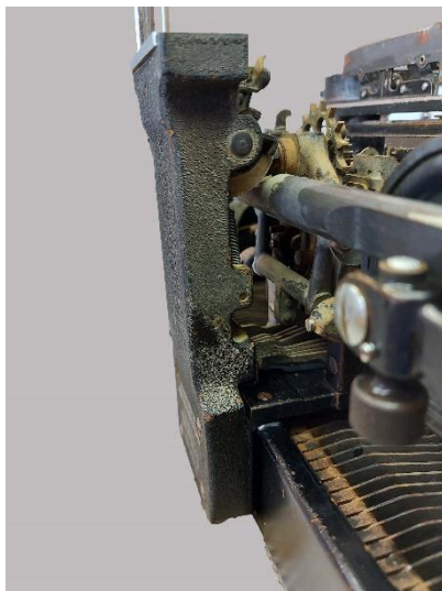
Εικόνα 119: Αποτέλεσμα στην βαφή κρακελέ επιφάνειας, μετά την δοκιμή καθαρισμού με NaOH 1% (πίσω όψη)
