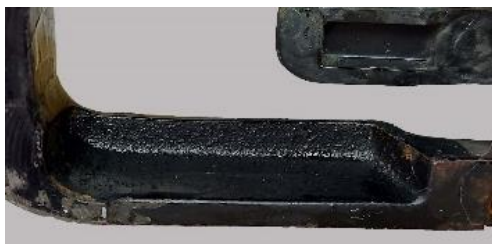
Εικόνα 130: Μετά την εφαρμογή NaOH 1% στην βαφή λείας επιφάνειας (κάτω όψη, αριστερά)
