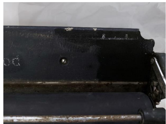
Εικόνα 95: Λεπτομέρεια από την μπροστινή όψη του φορέα της γραφομηχανής (πλάκα που ακουμπάει το χαρτί, δεξιά)
