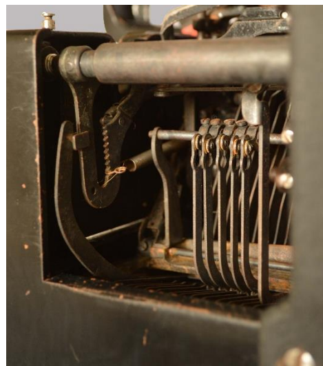
Εικόνα 219: Πίσω όψη γραφομηχανής μετά τον καθαρισμό (μεταλλικοί βραχίονες, αριστερή πλευρά)
