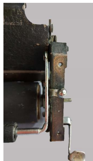
Εικόνα 236: Πάνω όψη του φορέα της γραφομηχανής μετά τον καθαρισμό (δεξιά πλευρά)
