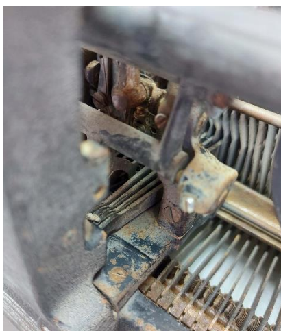
Εικόνα 53: Λεπτομέρεια στην πίσω όψη της γραφομηχανής (εστίαση στον μηχανισμό για την δημιουργία πινάκων)
