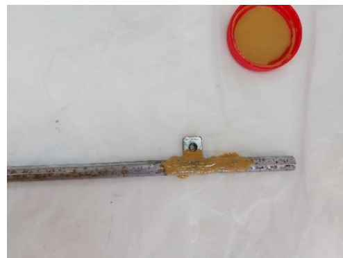
Εικόνα 134: Εφαρμογή πάστας κατιονικής ρητίνης σε επιμεταλλωμένο εξάρτημα του φορέα
