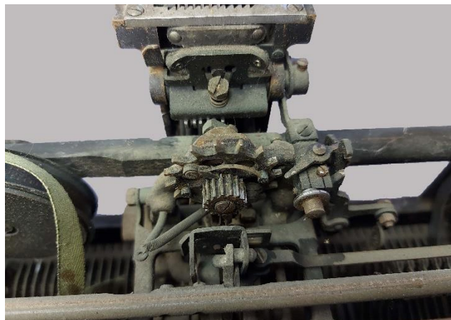
Εικόνα 78: Λεπτομέρεια από την πάνω όψη της γραφομηχανής μετά την αφαίρεση του φορέα (εστίαση στο κάτω μέρος του μηχανισμού δημιουργίας πινάκων)
