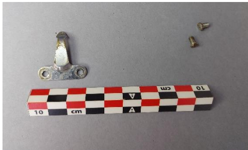
Εικόνα 101: Εξάρτημα που αφαιρέθηκε από τον φορέα της γραφομηχανής (δίκτης σημείου εκτύπωσης, πάνω όψη)
