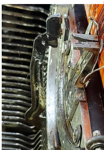
Εικόνα 166: Γραμμή τύπων πριν τον καθαρισμό με EDTA
