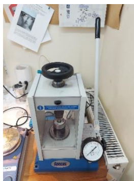
Εικόνα 102: Διαδικασίες δημιουργίας παστίλιας για την ανάλυση σε FTIR
