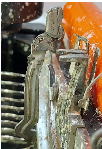
Εικόνα 170: Μετά τον καθαρισμό της γραμμής τύπων με EDTA
