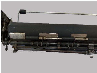
Εικόνα 235: Κάτω όψη του φορέα της γραφομηχανής μετά τον καθαρισμό (αριστερή πλευρά)
