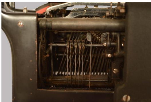
Εικόνα 220: Πίσω όψη γραφομηχανής, μετά τον καθαρισμό (μεταλλικοί βραχίονες, αριστερή πλευρά)
