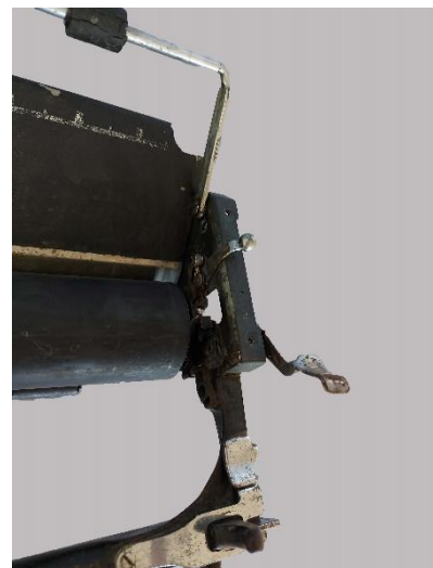
Εικόνα 96: Λεπτομέρεια από την μπροστινή όψη του φορέα της γραφομηχανής (εστίαση στους μηχανισμούς εσωτερικά, δεξιά)
