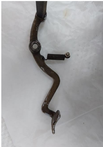
Εικόνα 137: Εξάρτημα του φορέα πριν τον χημικό μηχανικό καθαρισμό με EDTA 10% και σύρμα
