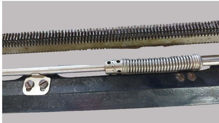
Εικόνα 154: Επιμεταλλωμένη ράβδος με δοντάκια πριν τον καθαρισμό με EDTA
