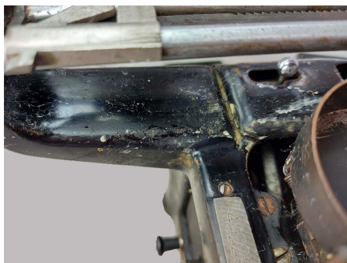
Εικόνα 125: Πριν την εφαρμογή NaOH 1% στην βαφή λείας επιφάνειας (πάνω όψη)
