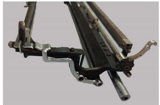
Εικόνα 246: Δεξιά όψη του φορέα της γραφομηχανής μετά τον καθαρισμό
