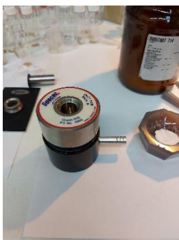
Εικόνα 102: Διαδικασίες δημιουργίας παστίλιας για την ανάλυση σε FTIR
