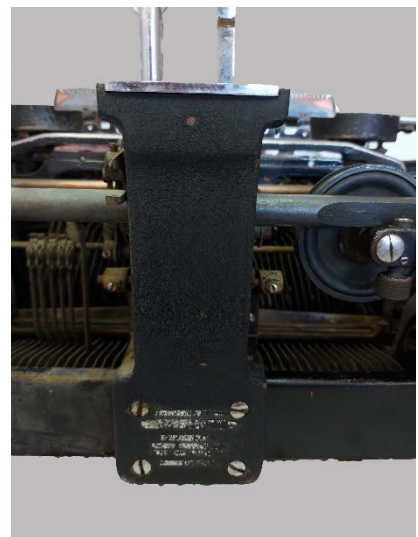
Εικόνα 120: Αποτέλεσμα στην βαφή κρακελέ επιφάνειας, μετά την δοκιμή καθαρισμού με NaOH 1% (πίσω όψη)
