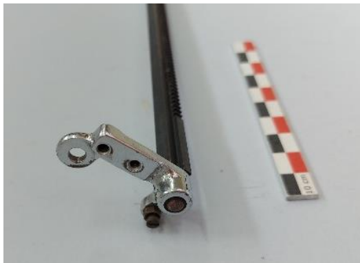
Εικόνα 139: Εξάρτημα του φορέα μετά τον χημικό μηχανικό καθαρισμό με EDTA 10% και σύρμα
