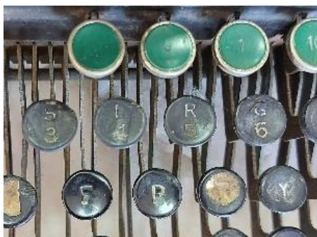
Εικόνα 178: Αποτέλεσμα μετά την εφαρμογή gel agar art στα πλήκτρα του πληκτρολογίου
