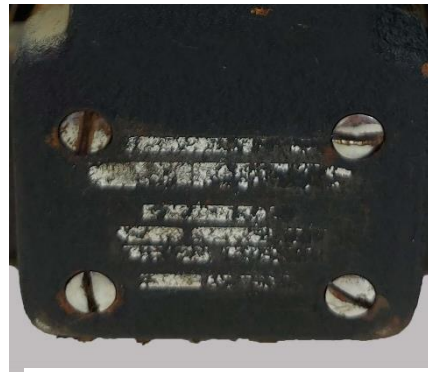
Εικόνα 181: Αποτέλεσμα επιφάνεια μετά τον καθαρισμό με NaOH
