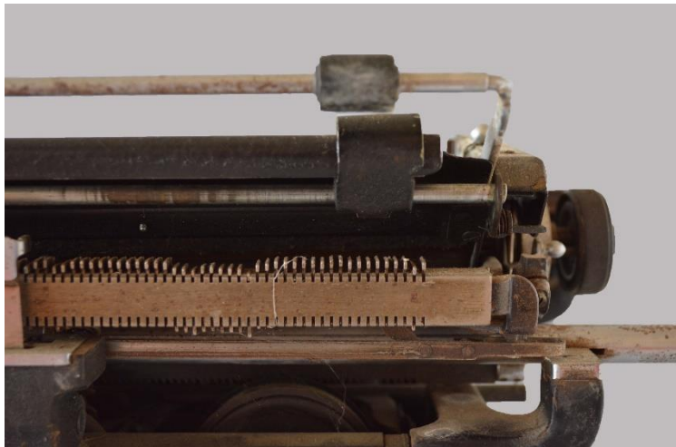
Εικόνα 56: Λεπτομέρεια στην πίσω όψη της γραφομηχανής (εστίαση στην οδοντωτή ράβδο για την δημιουργία πινάκων, δεξιά)
