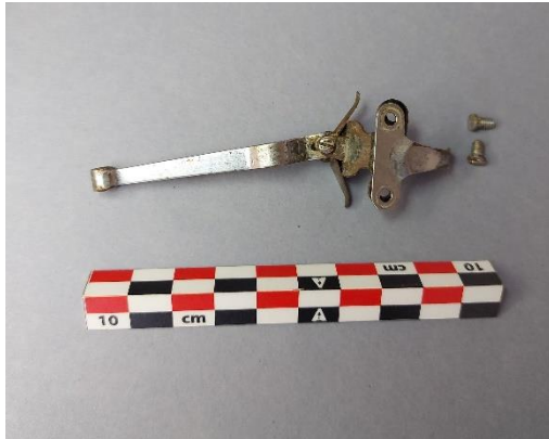
Εικόνα 99: Εξάρτημα που αφαιρέθηκε από τον φορέα της γραφομηχανής (δίκτης σημείου εκτύπωσης, πάνω όψη)
