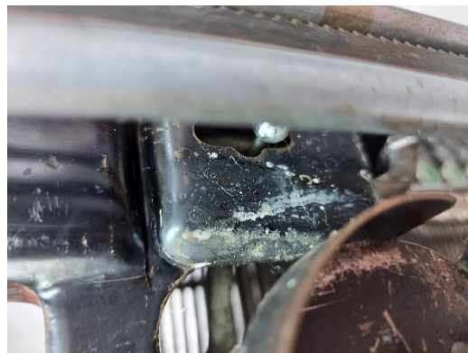
Εικόνα 124: Μετά την εφαρμογή NaOH 1% στην βαφή λείας επιφάνειας (πάνω όψη)
