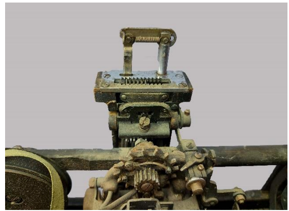
Εικόνα 77: Λεπτομέρεια από την πάνω όψη της γραφομηχανής μετά την αφαίρεση του φορέα (εστίαση στο πάνω μέρος του μηχανισμού δημιουργίας πινάκων)
