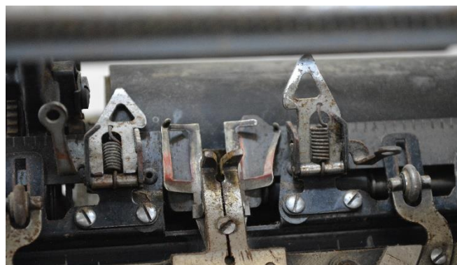
Εικόνα 10: Λεπτομέρεια από τη μπροστινή όψη της γραφομηχανής (εστίαση στους οδηγούς των γραμμών τύπων, της μελανοκορδέλας και της γραφής)
