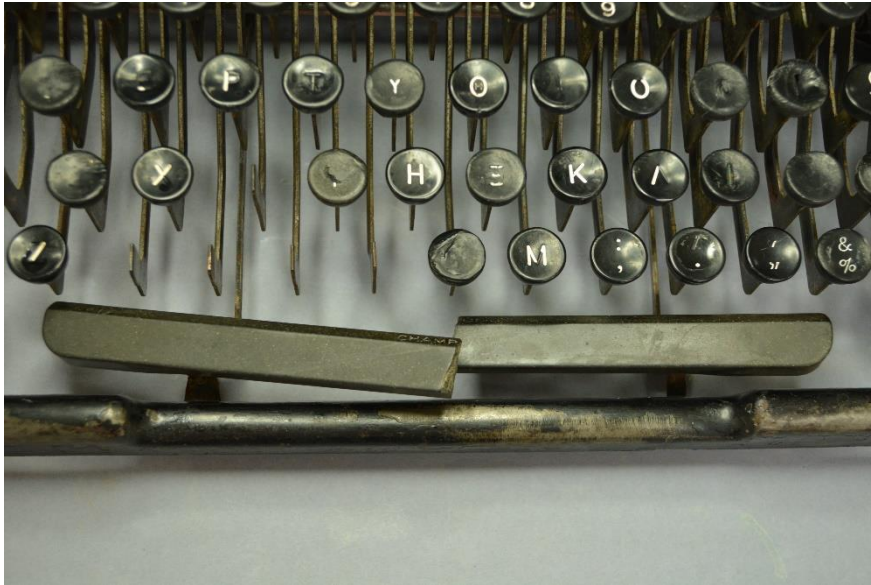
Εικόνα 193: Μπροστινή όψη της γραφομηχανής μετά τον καθαρισμό (πλήκτρα και κουμπί space)
