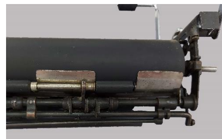
Εικόνα 233: Κάτω όψη του φορέα της γραφομηχανής μετά τον καθαρισμό (δεξιά πλευρά)
