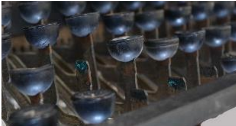
Εικόνα 12: Λεπτομέρειες στην μπροστινή όψη του πληκτρολογίου (εστίαση στις γαλάζιες επικαθίσεις στις απολήξεις των γραμμών τύπων με τα πλήκτρα)
