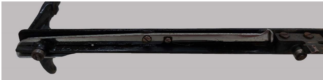
Εικόνα 157: Επιμεταλλωμένο εξάρτημα μετά τον καθαρισμό με EDTA
