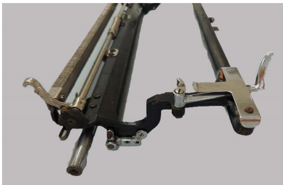
Εικόνα 247: Αριστερή όψη του φορέα της γραφομηχανής μετά τον καθαρισμό
