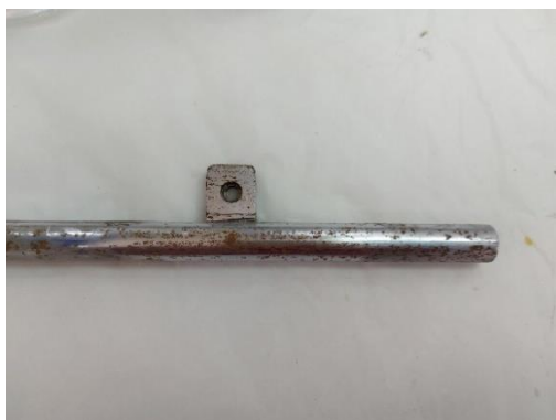
Εικόνα 135: Μετά την εφαρμογή πάστας cationic σε επιμεταλλωμένο εξάρτημα του φορέα
