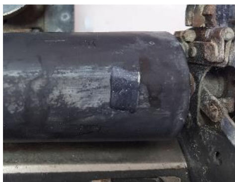
Εικόνα 177: Εφαρμογή gel agar art & απιονισμένο νερό στον κύλινδρο
