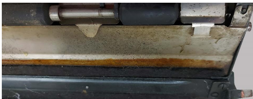
Εικόνα 158: Επιμεταλλωμένη επιφάνεια πριν τον καθαρισμό με EDTA (πίσω όψη πλάκας πιεστηρίου)
