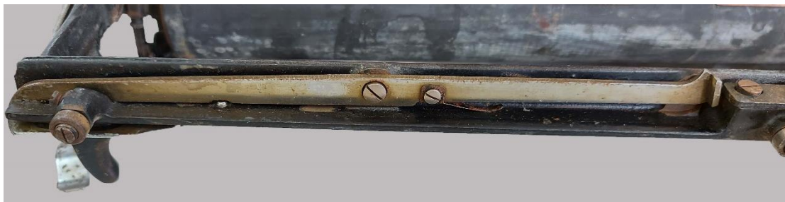
Εικόνα 156: Επιμεταλλωμένο εξάρτημα πριν τον καθαρισμό με EDTA
