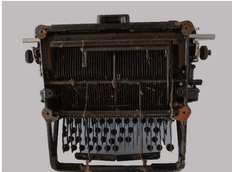
Εικόνα 55: Λεπτομέρεια στην πίσω όψη της γραφομηχανής (εστίαση στην οδοντωτή ράβδο για την δημιουργία πινάκων, αριστερά)
