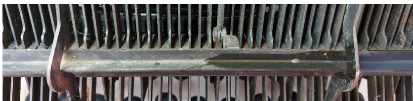
Εικόνα 175: Καθαρισμός μεταλλικού τμήματος με EDTA (κάτω όψη)
