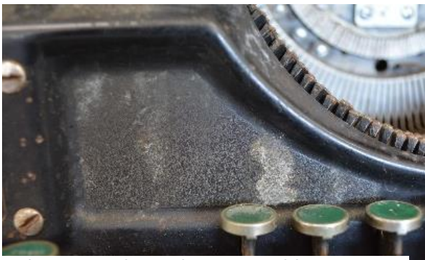
Εικόνα 8: Λεπτομέρεια από την μπροστινή όψη της γραφομηχανής (εστίαση σε τρεξίματα στην βαφή αριστερά)
