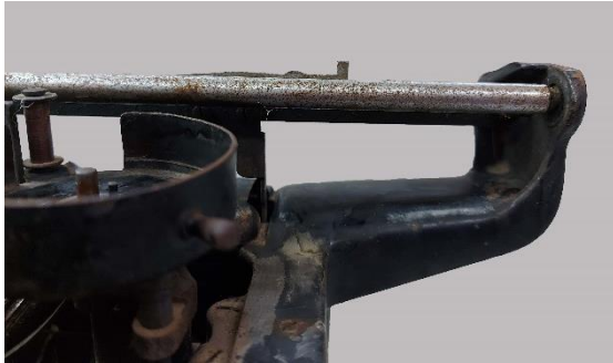
Εικόνα 147: Επιμεταλλωμένη ράβδος μετά τον καθαρισμό με EDTA
