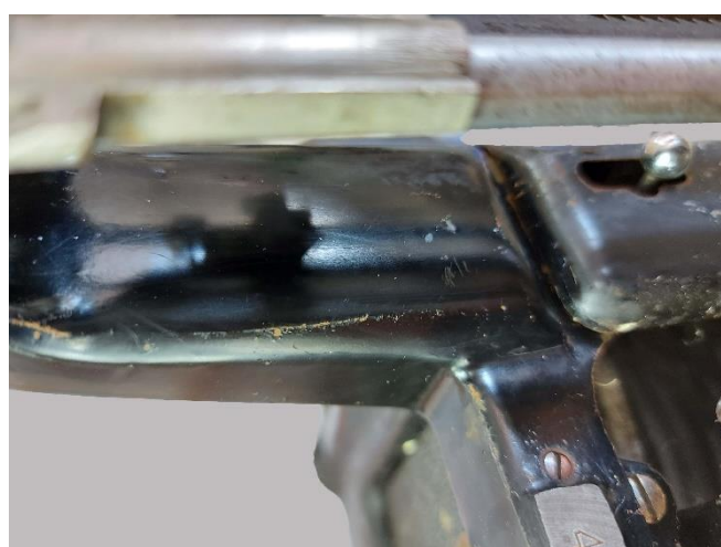
Εικόνα 126: Μετά την εφαρμογή NaOH 1% στην βαφή λείας επιφάνειας (πάνω όψη)
