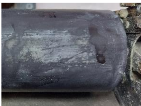
Εικόνα 176: Αποτέλεσμα μετά την εφαρμογή gel agar art στον κύλινδρο
