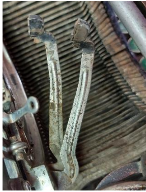
Εικόνα 160: Αποτελέσματα καθαρισμού γραμμών τύπων με gel agar art & EDTA
