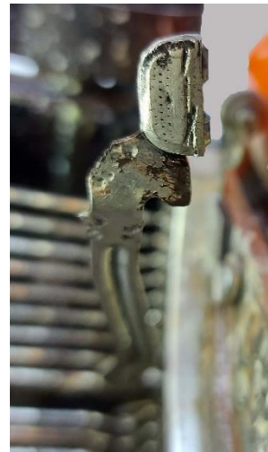
Εικόνα 171: Πριν τον καθαρισμό της γραμμής τύπων με EDTA
