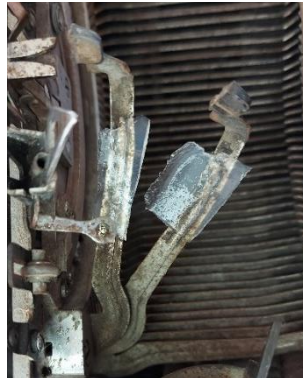
Εικόνα 162: Δοκιμή καθαρισμού γραμμών τύπων με gel agar art & EDTA
