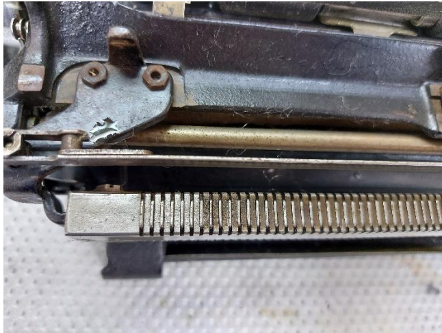
Εικόνα 153: Επιμεταλλωμένη ράβδος με δοντάκια κατά την διάρκεια του καθαρισμού με EDTA
