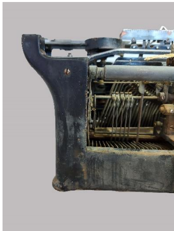
Εικόνα 118: Αποτέλεσμα στην βαφή λείας επιφάνειας, μετά την δοκιμή καθαρισμού με NaOH 1%
