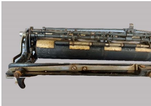
Εικόνα 90: Κάτω όψη του φορέα της γραφομηχανής (δεξιά)
