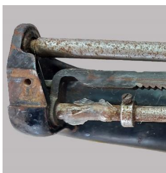
Εικόνα 142: Εφαρμογή gel agar art & EDTA
