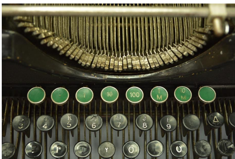
Εικόνα 191: Μπροστινή όψη της γραφομηχανής μετά τον καθαρισμό (πληκτρολόγιο και γραμμές τύπων)
