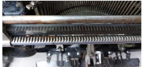
Εικόνα 149: Επιμεταλλωμένη ράβδος με δοντάκια πριν το καθαρίσιμα με EDTA
