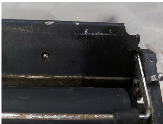
Εικόνα 94: Λεπτομέρεια από την μπροστινή όψη του φορέα της γραφομηχανής (πλάκα που ακουμπάει το χαρτί, δεξιά)
