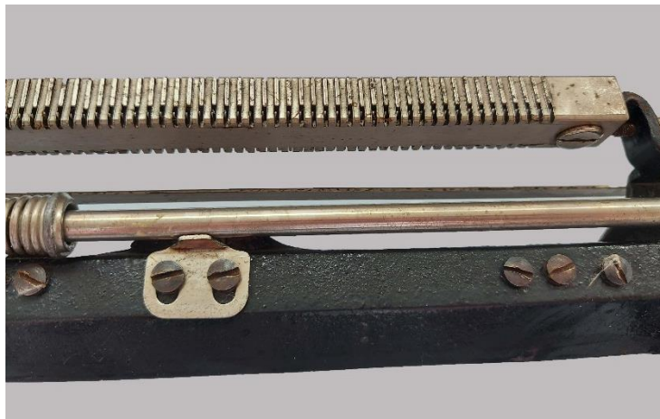
Εικόνα 155: Επιμεταλλωμένη ράβδος με δοντάκια μετά τον καθαρισμό με EDTA
