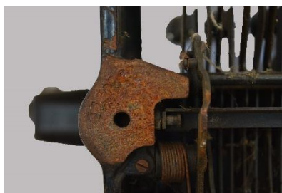
Εικόνα 67: Λεπτομέρειες στην κάτω όψη της γραφομηχανής (τρία από τα τέσσερα στηρίγματα της γραφομηχανής, στο πρώτο αναγράφεται αριθμός της πατέντας «1150203»)
