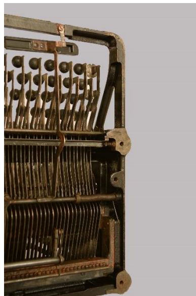
Εικόνα 228: Κάτω όψη γραφομηχανής (μεταλλικοί βραχίονες, δεξιά πλευρά)
