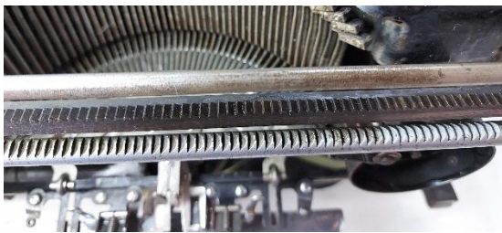
Εικόνα 148: Επιμεταλλωμένη ράβδος με δοντάκια, μετά τον καθαρισμό με EDTA
