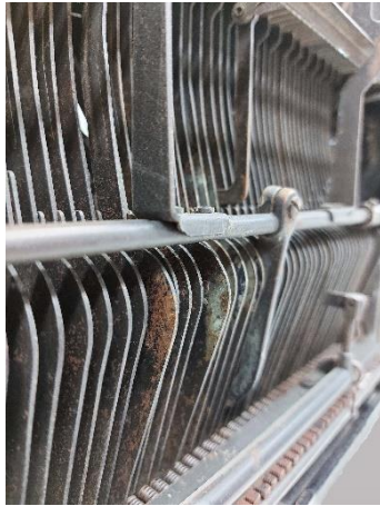
Εικόνα 68: Λεπτομέρεια στην κάτω όψη της γραφομηχανής (εστίαση στα προϊόντα διάβρωσης των βραχιόνων των γραμμών τύπων)
