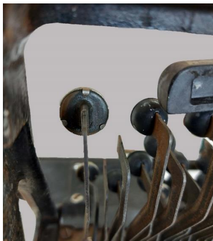
Εικόνα 15: Λεπτομέρεια από την κάτω όψη του πληκτρολογίου (εστίαση στη μεταλλική στεφάνη που περιβάλλει το πλήκτρο)
