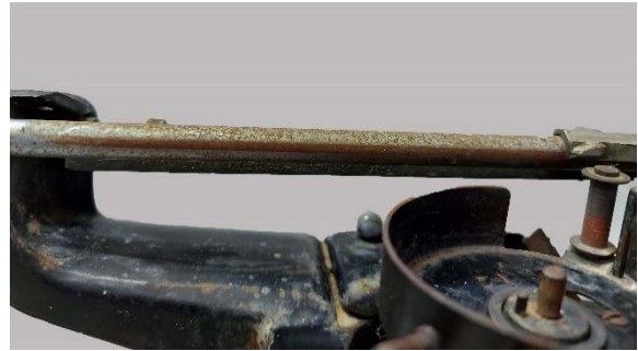
Εικόνα 144: Επιμεταλλωμένη ράβδος πριν τον καθαρισμό με EDTA
