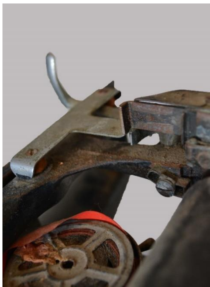
Εικόνα 27: Λεπτομέρεια από το μπροστινό μέρος της γραφομηχανής (μελανοκορδέλα δεξιά)
