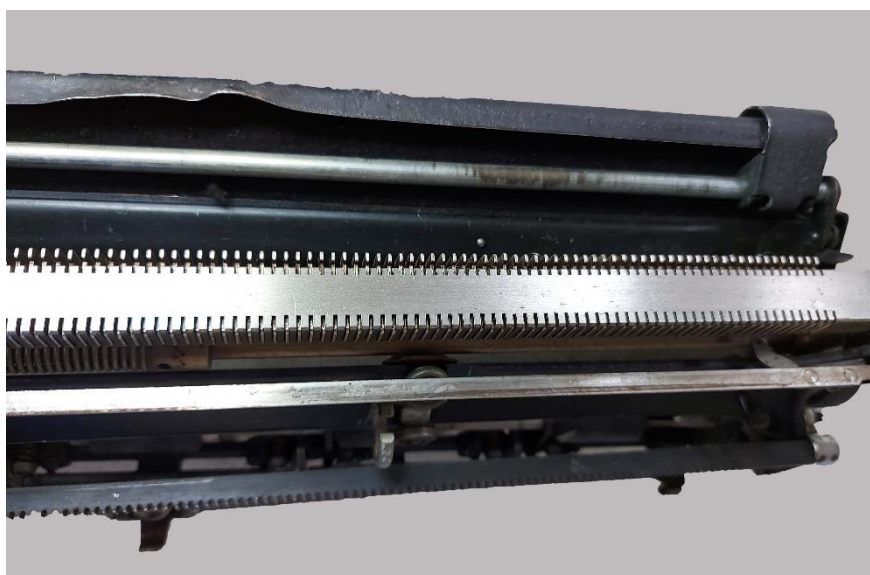
Εικόνα 152: Επιμεταλλωμένη ράβδος μετά την δεύτερη εφαρμογή EDTA (με σύρμα)
