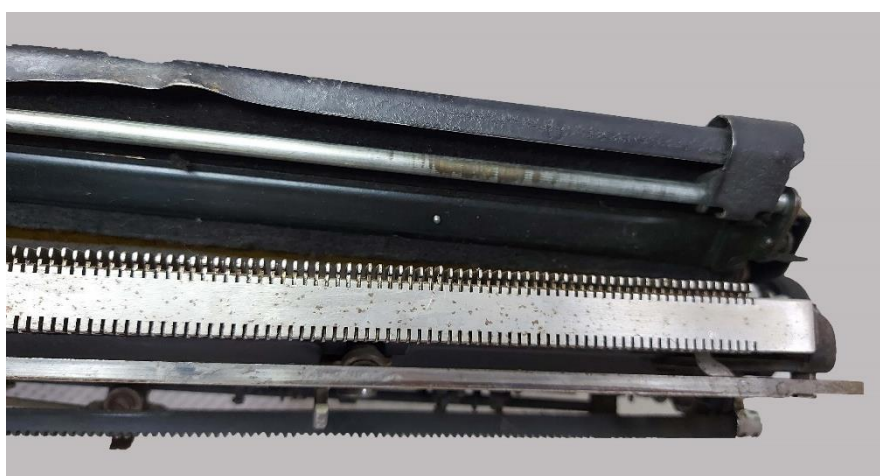
Εικόνα 151: Επιμεταλλωμένη ράβδος μετά την πρώτη εφαρμογή EDTA (με βαμβάκι)
