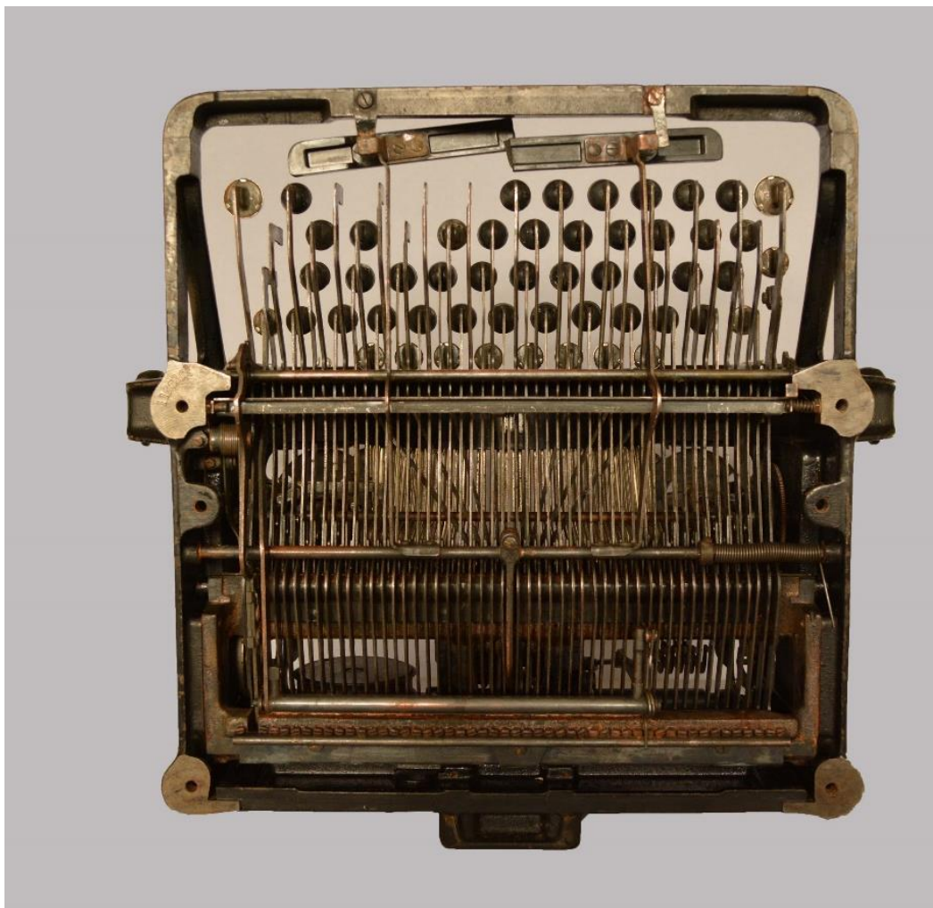
Εικόνα 221: Κάτω όψη γραφομηχανής μετά τον καθαρισμό
