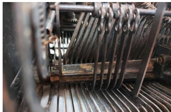
Εικόνα 49: Λεπτομέρειες στην πίσω όψη της γραφομηχανής (εστίαση στις γραμμές τύπων)
