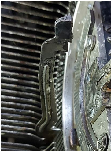
Εικόνα 163: Γραμμή τύπων πριν τον καθαρισμό με EDTA
