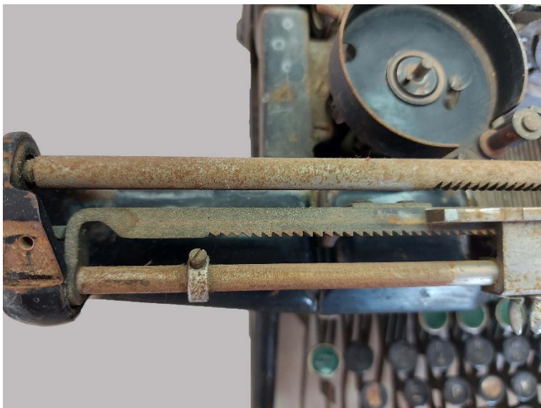
Εικόνα 140: Επιμεταλλωμένες ράβδοι στο μπροστινό μέρος της γραφομηχανής, πριν τον καθαρισμό
