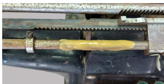
Εικόνα 141: Εφαρμογή πάστας cationic
