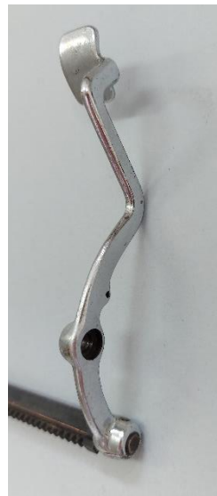
Εικόνα 136: Εξάρτημα του φορέα μετά τον χημικό μηχανικό καθαρισμό με EDTA 10% και σύρμα
