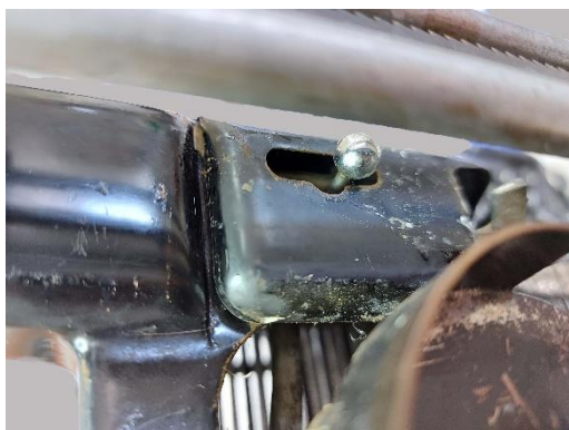
Εικόνα 123: Πριν την εφαρμογή NaOH 1% στην βαφή λείας επιφάνειας (πάνω όψη)
