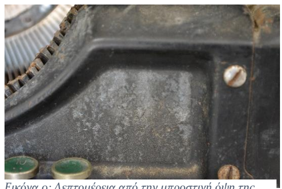
Εικόνα 9: Λεπτομέρεια από την μπροστινή όψη της γραφομηχανής (εστίαση σε τρεξίματα στην βαφή, δεξιά)
