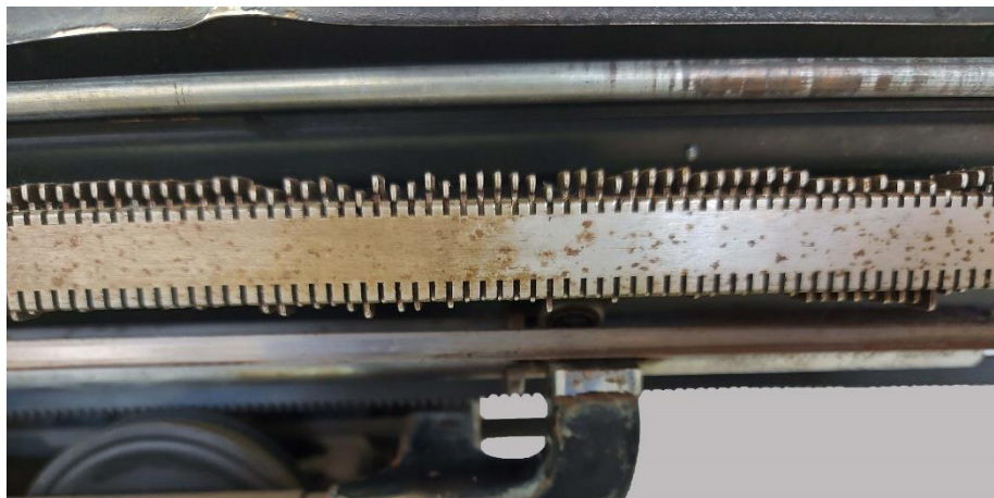
Εικόνα 150: Επιμεταλλωμένη ράβδος κατά την διάρκεια του καθαρισμού με EDTA
