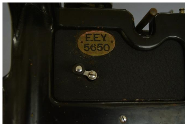
Εικόνα 211: Δεξιά όψη γραφομηχανής μετά τον καθαρισμό (μοχλός που κινεί τα καρούλια της μελανοκορδέλας, ταμπέλα της ΕΥΔΑΠ)
