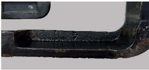
Εικόνα 128: Μετά την εφαρμογή NaOH 1% στην βαφή λείας επιφάνειας (κάτω όψη, δεξιά)
