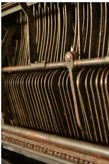
Εικόνα 229: Κάτω όψη γραφομηχανής (μεταλλικοί βραχίονες)
