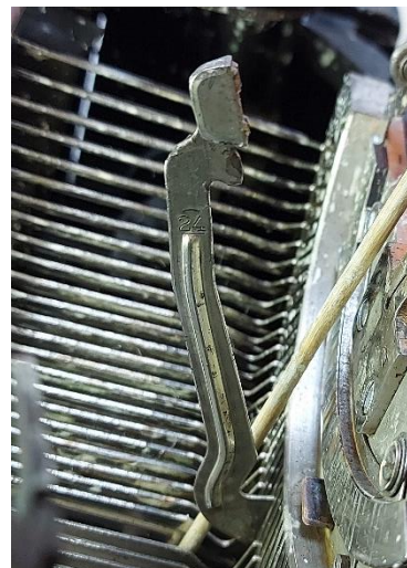
Εικόνα 164: Γραμμή τύπων μετά τον καθαρισμό με EDTA
