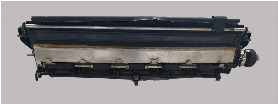
Εικόνα 231: Κάτω και πίσω όψη του φορέα της γραφομηχανής μετά τον καθαρισμό
