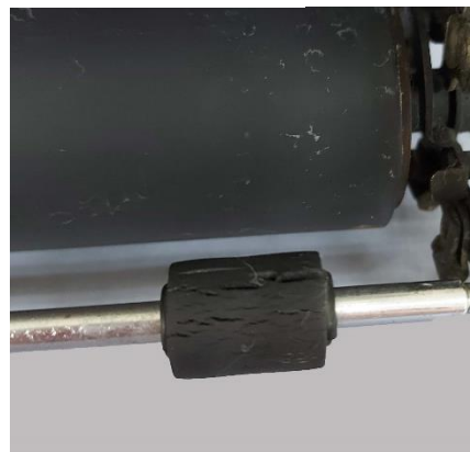
Εικόνα 240: Μπροστινή όψη του φορέα της γραφομηχανής μετά τον καθαρισμό (μικροί κύλινδροι)
