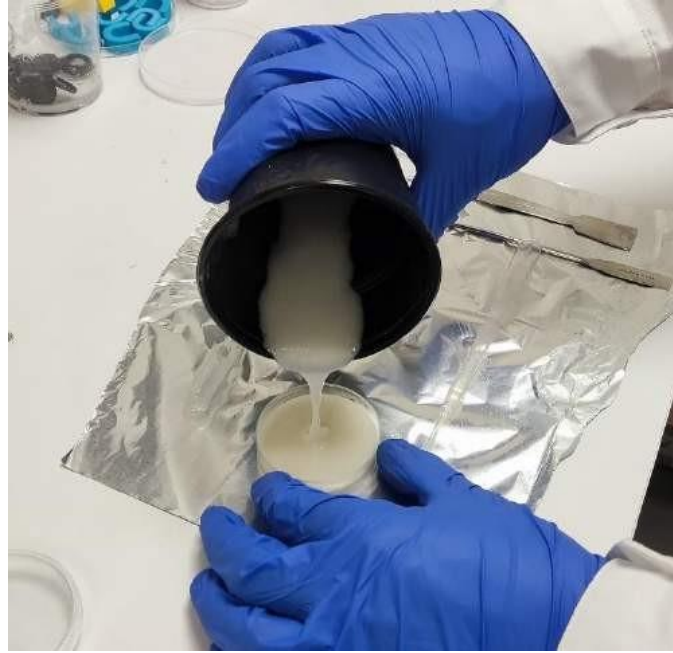
Εικόνα 44: Έγχυση εξεταζόμενου υλικού στο κυκλικό καλούπι 13) Σφραγίζουμε με το φιλμ το εξεταζόμενο δοκίμιο και το τοποθετούμε στο ψυγείο για ψύξη
