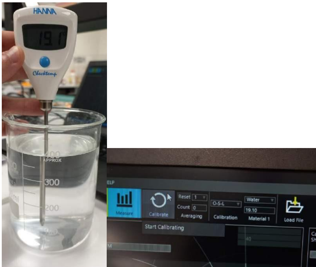
Εικόνα 55: Θερμοκρασία πρότυπου υλικού (απιονισμένο νερό) & εκκίνηση βαθμονόμησης
