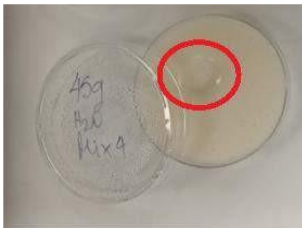
Εικόνα 73: Προεξοχή του μείγματος 3 της 1 ης σειράς αρχικού πρωτόκολλου 2 η σειρά δοκιμών – Μείγμα 1: Κακή ανάμιξη, πολύ σιλικόνη στη μετρούμενη επιφάνεια, μειώνει σημαντικά τη διηλεκτρική σταθερά του υλικού.
