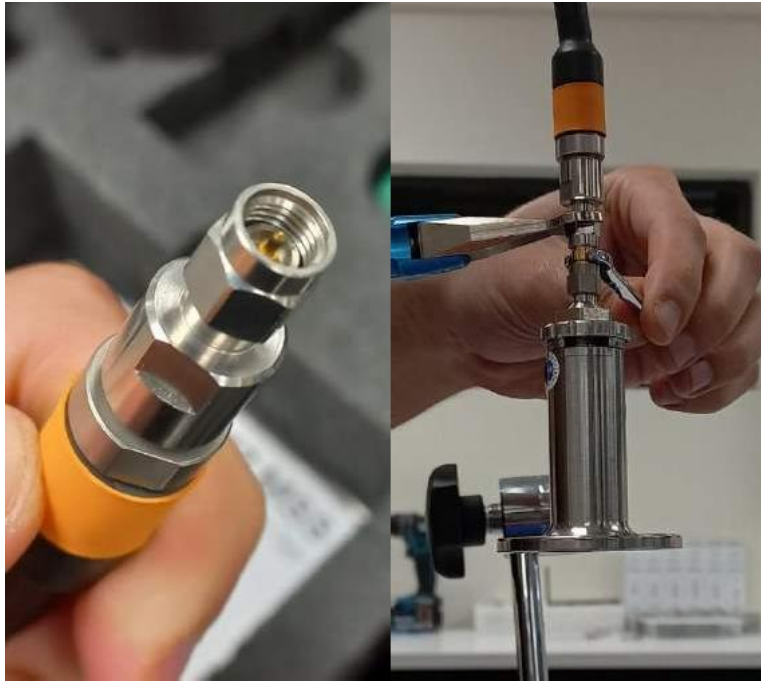
Εικόνα 50: Σύνδεση καλωδίου σταθερότητας
