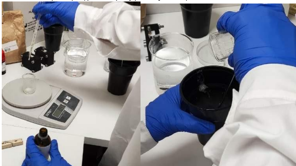
Εικόνα 43: Μέτρηση & προσθήκη καταλύτη στο μείγμα
