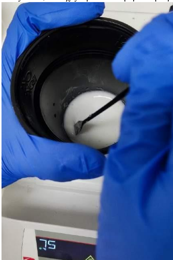
Εικόνα 41: Ανάμειξη στους 75°C για 6'
