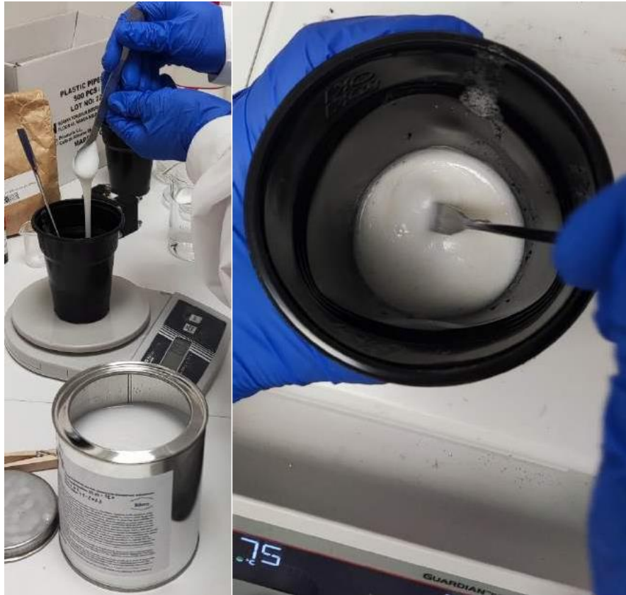
Εικόνα 42: Προσθήκη & ανάμειξη σιλικόνης στο μείγμα
