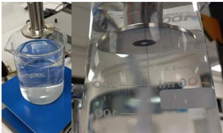
Εικόνα 58: Βύθιση ομοαξονικού ανιχνευτή
