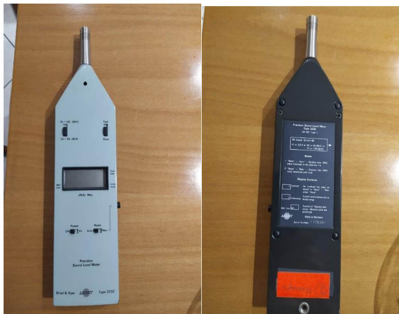
Εικόνα 4: Το ηχώμετρο "Bruel & Kjaer", μοντέλο 2232, που χρησιμοποιήθηκε για τη μέτρηση του θορύβου στα καταστήματα υγειονομικού ενδιαφέροντος στην Αθήνα.
