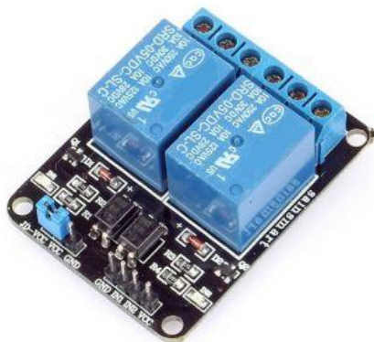
Εικόνα 5.6 Relay Module - 2 Channel 5V
