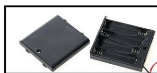
Εικόνα 5.8 4xAA battery holder with cover and switch
