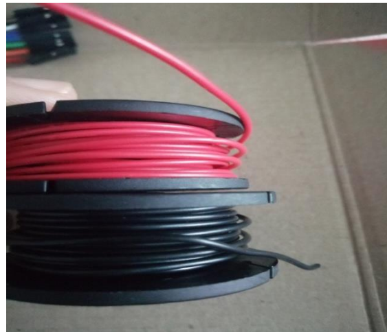
Εικόνα 5.2 3 είδη Καλωδίων Μονόκλινα 22AWG / 0.32mm – Κόκκινο, Μαύρο κ Κίτρινο 7.5m
