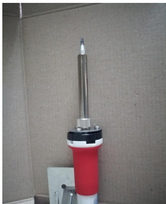
Εικόνα 5.14 κολλητήρι συγκόλλησης καλωδίων
