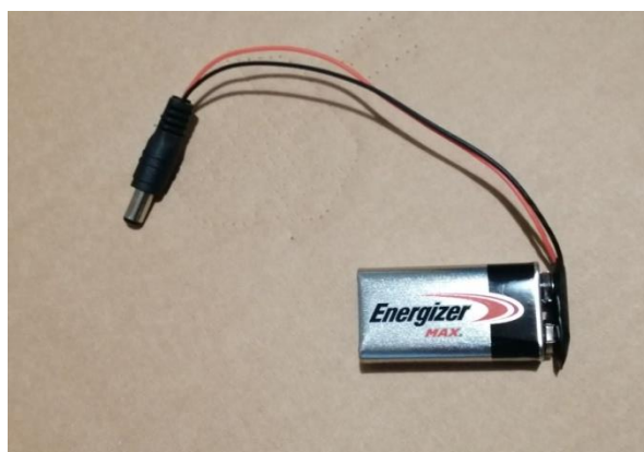
Εικόνα 5.7 9Volt Batteries clip
