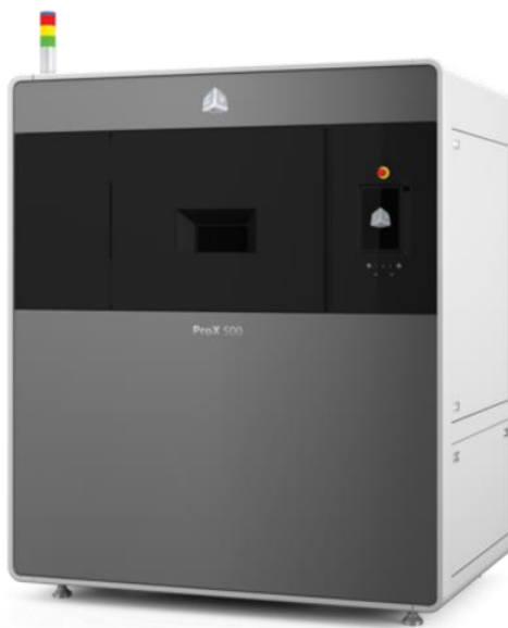
Εικόνα 8 : Παράδειγμα Powder Bed Fusion εκτυπωτή.
