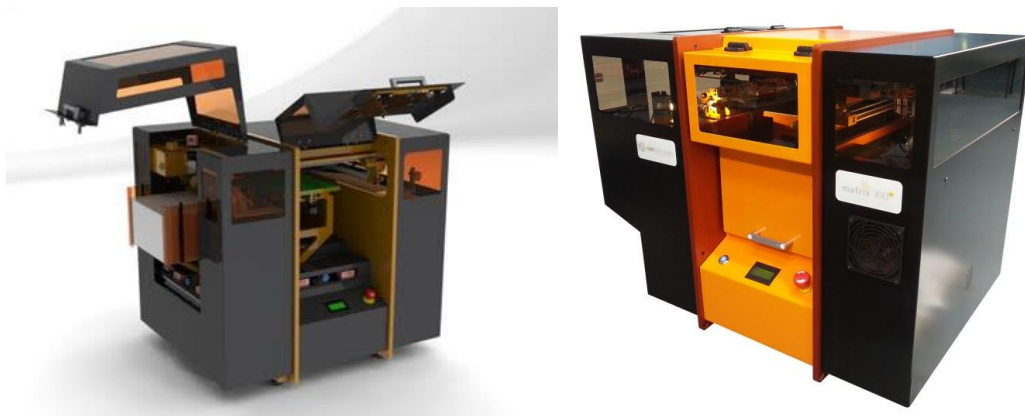
Εικόνα 12 : Παράδειγμα Sheet Lamination εκτυπωτή.
