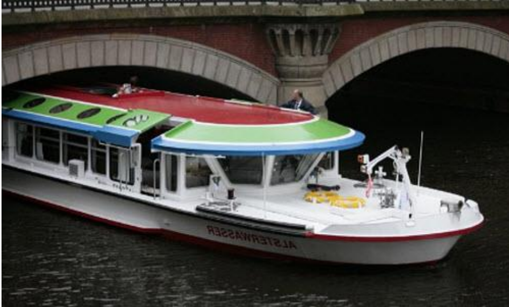
Εικόνα 14: Το πρώτο πλοίο με κυψέλες καυσίμου [32]
