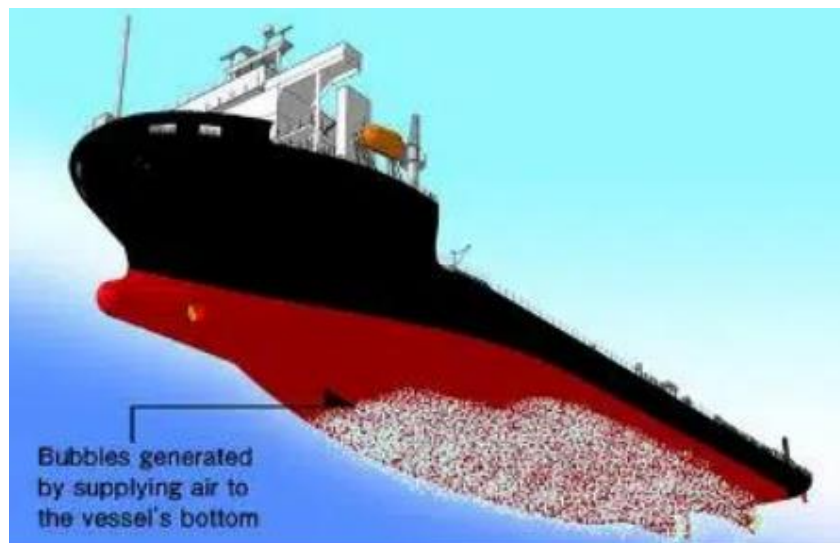
Εικόνα 11: Σύστημα χρήσης του αέρα ως λιπαντικό [25]
