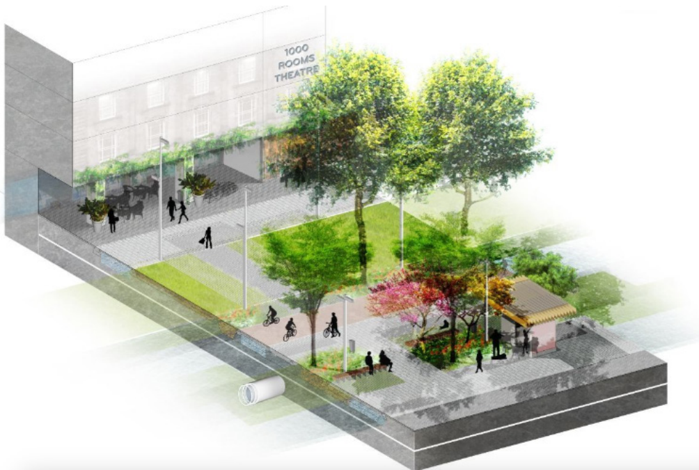
Εικόνα 25 - Φύτευση πράσινου και αποθήκευση βρόχινου νερού
