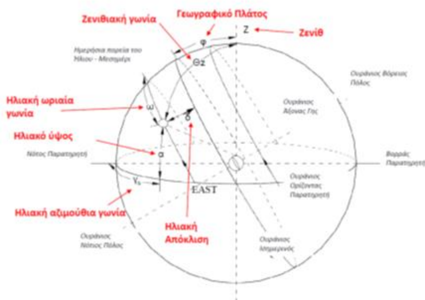
Εικόνα 3 Παράμετροι τοποθέτησης φωτοβολταϊκού συστήματος
