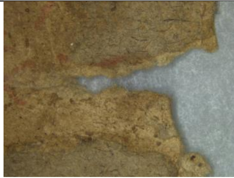
Εικ. 20 Σημείο που αποτυπώνει τον φορέα, το επικολημένο χαρτί και υπολείμματα συγκολλητικής ουσίας (9) (στερεομικροσκόπιο)
