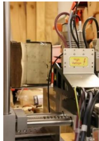
Εικ. 3. 12 Ο σαρωτής MA-XRF που αναπτύχθηκε από τον Joris Dik και την ομάδα του στο Πανεπιστήμιο του Delft (Kwakkel, 2015)
