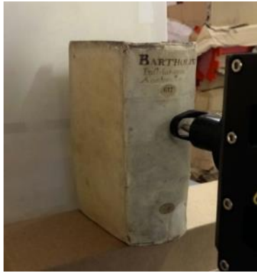
Εικ. 3. 13 Κατά τη διαδικασία σάρωσης με MA-XRF σε βιβλίο του 16 ου αιώνα (Kwakkel, 2015)
