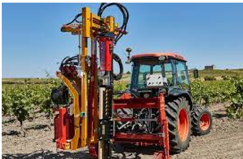
Εικ.9. Ωθητής πασσάλων (Pile pusher. Domenico Pessina, 2020)
