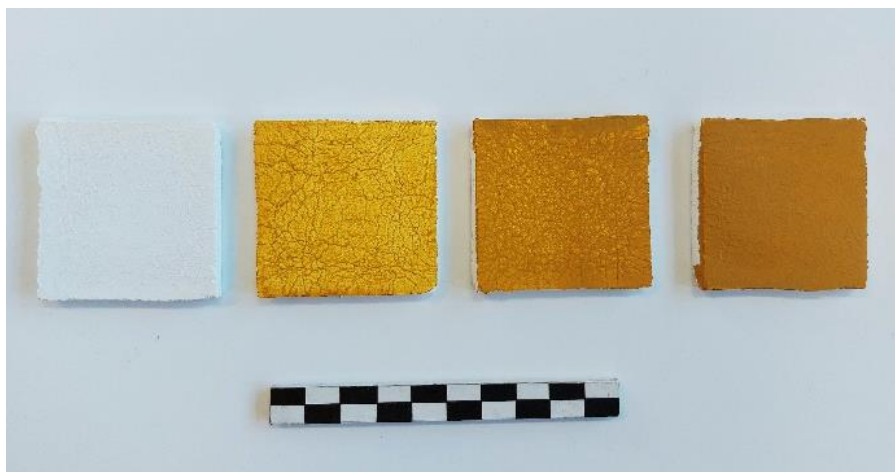
Εικ. 3.3 Δοκίμια αναφοράς με τα ζωγραφικά στρώματα ξεχωριστά.
