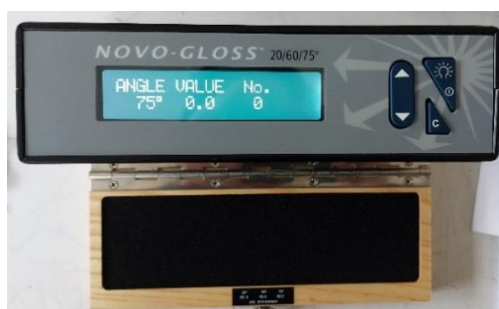
Εικόνα 3.25 Διαδικασία βαθμονόμησης του οργάνου.
