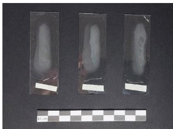
Εικ. 3.9 Δείγματα επικαλυπτικού σε αντικειμενοφόρες πλάκες.
