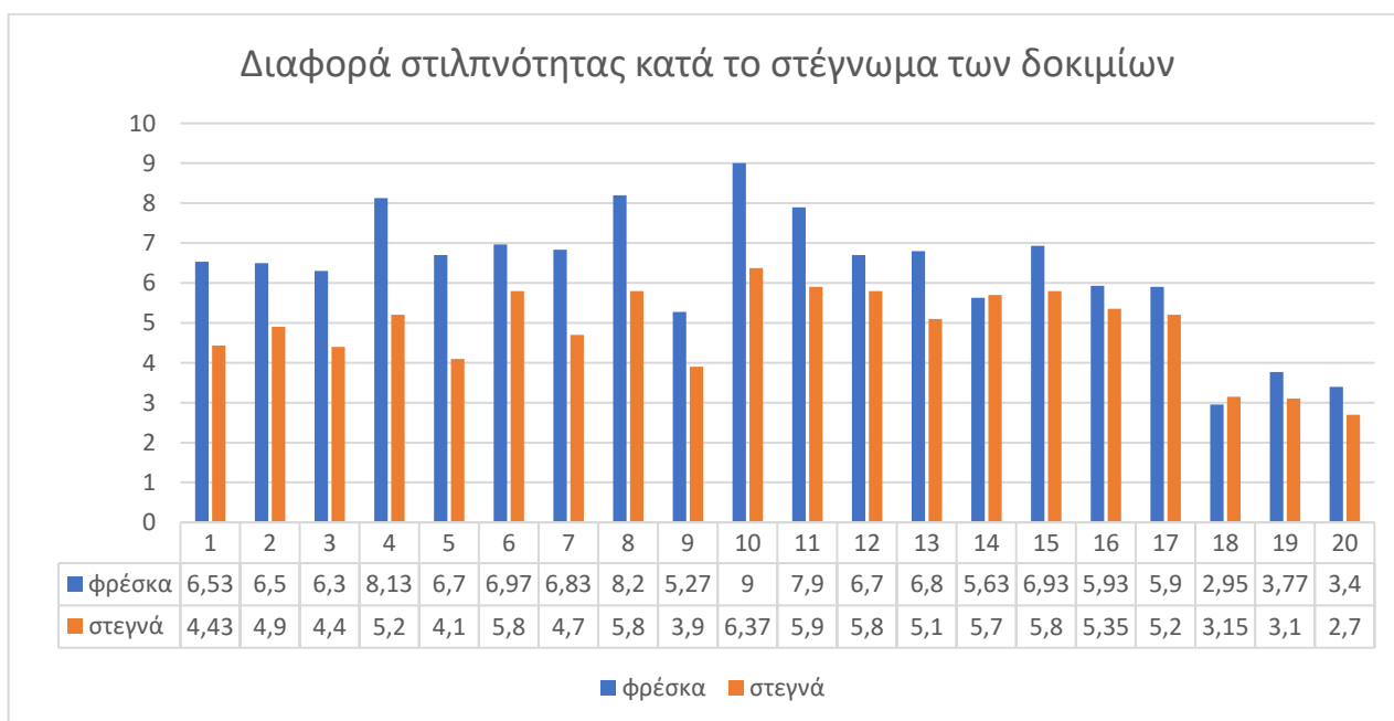
Σχ. 4.4 Μετρήσεις στυλπνότητας κατά το στέγνωμα των δοκιμίων.
