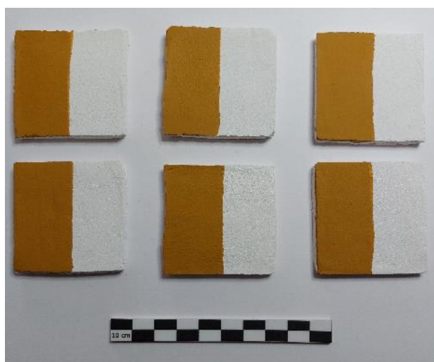
Εικ.3.5 Δοκίμια με τρεις στρώσεις χρώματος στην μισή επιφάνεια του δοκιμίου.
