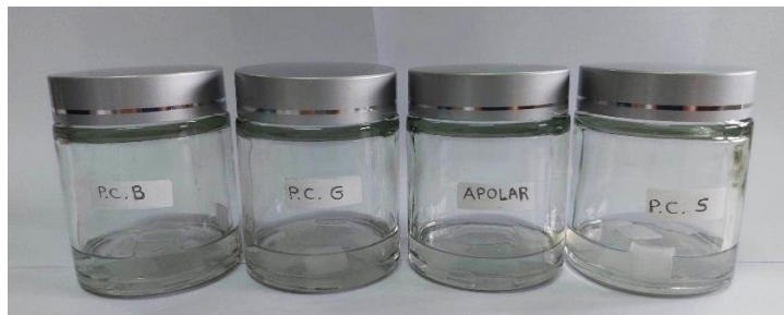
Εικ. 3.15 Απεικόνιση της αποθήκευσης των υδρογελών κατά τον εμποτισμό τους στα νανοδομημένα υδατικά συστήματα Nanostore Cleaning®: Polar Coating S, Polar Coating B, Polar Coating G και Apolar.
