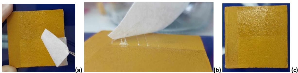
Εικ. 4.24 Κατά την αφαίρεση του Evolon®CR με το Apolar (a), όπου διακρίνεται η ενεργοποίηση και αποκόλληση του επικαλυπτικού από τη ζωγραφική επιφάνεια (b) και το ομοιόμορφο αποτέλεσμα μετά την πλήρη αφαίρεση του (c).
