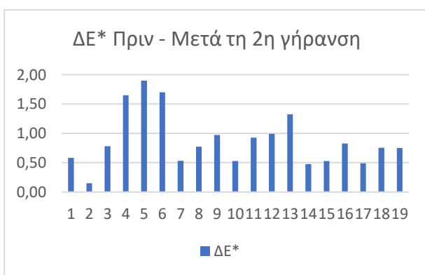
Σχ. 4.10 Παρουσίαση αποτελεσμάτων χρωματομετρίας L^* (a), a^* (b), b^* (c) και \Delta E^* (d), που προκύπτουν από τις μετρήσεις που λήφθηκαν πριν και μετά την δεύτερη φάση γήρανσης των δοκιμών.
