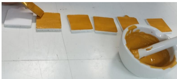
Εικ. 3.2 Εφαρμογή του ζωγραφικού στρώματος με την χρήση πινέλου.
