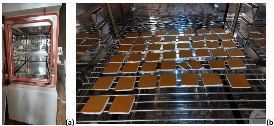
Εικ.3.10 Εξωτερικό του θαλάμου (a), Εσωτερικό του θαλάμου γήρανσης, τοποθέτηση των δοκιμίων (b).
