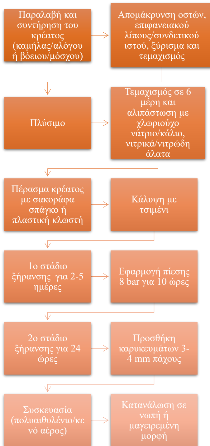
Εικόνα 5: Διάγραμμα ροής βιομηχανικής παραγωγής του παστουρμά
