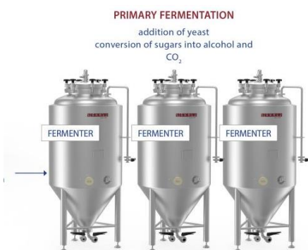
Εικόνα 3. 15: Δεξαμενές για τη πρωταρχική ζύμωση (βιομηχανικές συνθήκες)
