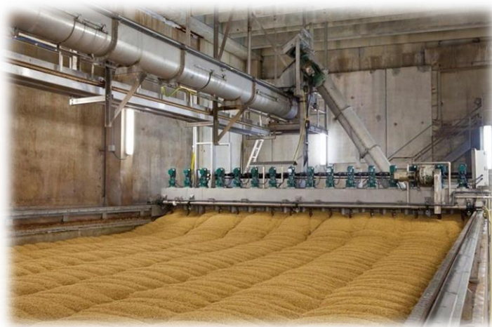
Εικόνα 3. 4: Δοχείο εκβλάστησης (βιομηχανικές συνθήκες)
