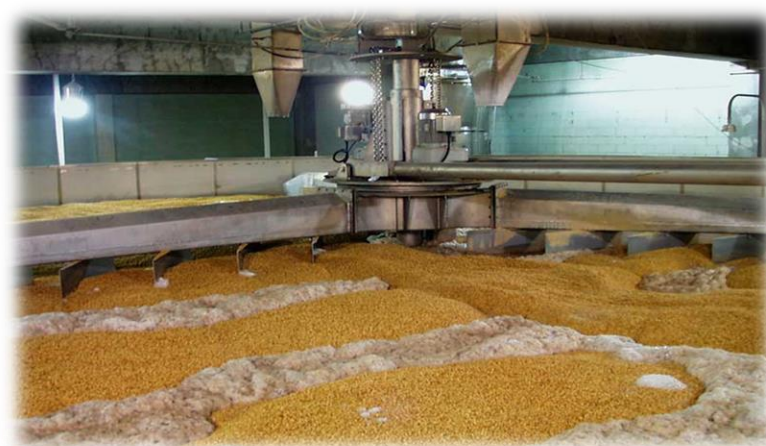
Εικόνα 3. 2: Διαβροχή κόκκων κριθαριού σε δεξαμενή επίπεδου πυθμένα (βιομηχανικές συνθήκες)
