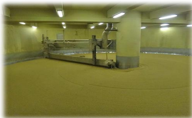
Εικόνα 3. 6: Κλιβανός ξήρανσης (βιομηχανικές συνθήκες)
