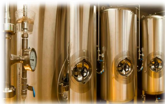
Εικόνα 3. 16: Δεξαμενές Bright Beer Tanks-BBT (βιομηχανικές συνθήκες)
