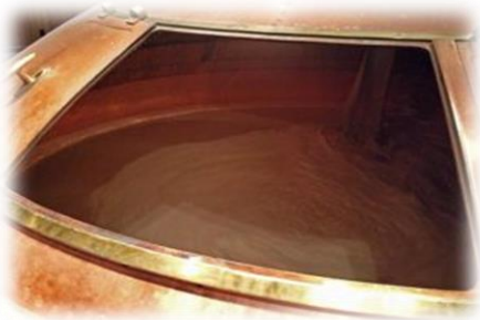
Εικόνα 3. 12: Βρασμός ζυθογλεύκους (βιομηχανικές συνθήκες)
