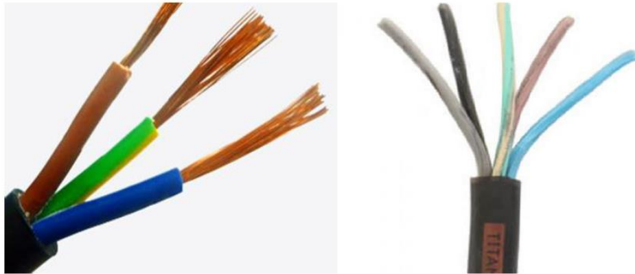
Σχήμα 1.10 : Μονοφασικό (αριστερά) και τριφασικό (δεξιά) καλώδιο. Με μπλε χρώμα διακρίνεται ο ουδέτερος αγωγός, με κίτρινο και πράσινο χρώμα ο αγωγός προστασίας. Οι υπόλοιποι αγωγοί αντιστοιχούν στις φάσεις.
