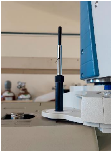
Εικόνα 4.7.2. Η συσκευή SPME στο septum του εισαγωγέα και η συνολική διάταξη του GC-MS (Προσωπικά αρχεία).
