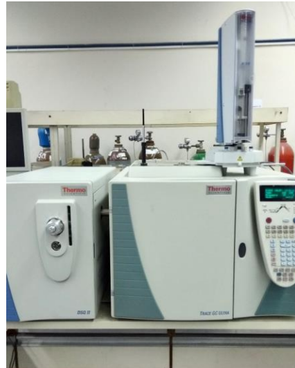
Εικόνα 4.7.2. Η συσκευή SPME στο septum του εισαγωγέα και η συνολική διάταξη του GC-MS (Προσωπικά αρχεία).
