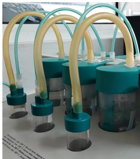
Εικόνα 4.9. Η πειραματική διάταξη σχηματικά και πραγματικά (Manual 743 Rancimat, 2021; Προσωπικό αρχείο).
