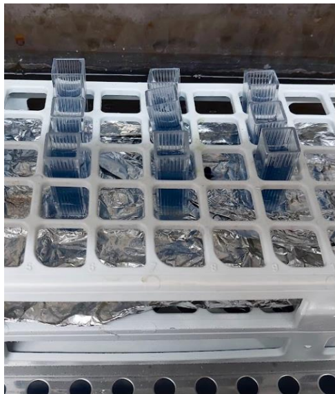
Εικόνα 4.8.2. Τα δείγματα στο υδατόλουτρο και το φασματοφωτόμετρο στο οποίο θα οδηγηθούν (Προσωπικά αρχεία).
