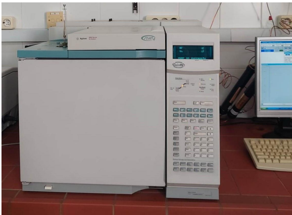
Εικόνα 10 Ο αέριος χρωματογράφος Agilent 6890 Series Gas Chromatograph του Εργαστηρίου Ενόργανης Ανάλυσης που χρησιμοποιήθηκε
