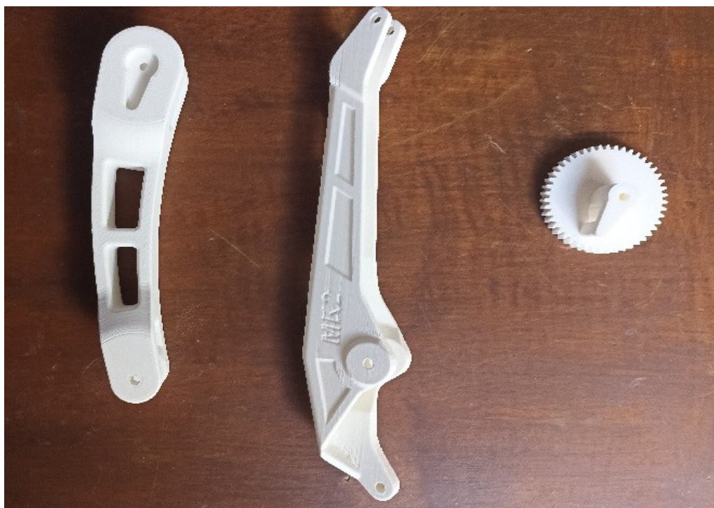
Εικόνα 2.3:Εκτυπωμένα εξαρτήματα του ρομπότ. Αριστερά ο σύνδεσμος που συνδέει τη βάση με την άρθρωση. Στο κέντρο μέρος της εικόνας ο σύνδεσμος που ενώνει την άρθρωση με την αρπάγη. Δεξιά είναι το γρανάζι με το οποίο κινητήρες δίνουν κίνηση. [φωτογραφία]
