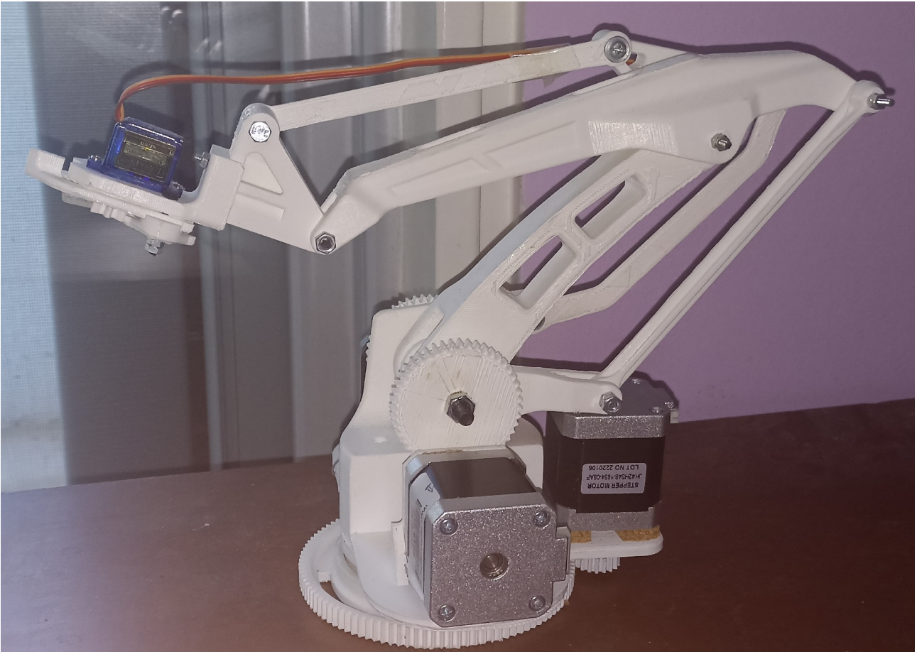
Εικόνα 4.1: Τελική μορφή του βραχίονα μετά την συναρμολόγηση και την τοποθέτηση των κινητήρων [Φωτογραφία]
