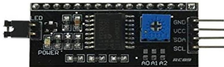
Εικόνα 4.7 Πλακέτα αντάπτορας της παράλληλης θύρας των LCD σε διεπαφή I 2 C (SUNFOUNDER, 2017)
