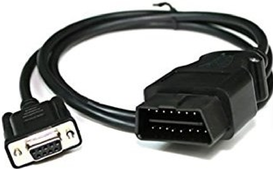
Εικόνα 4.8 Καλώδιο DB9 σε DLC (SUNFOUNDER, 2017)
