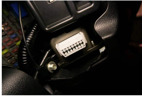
Εικόνα 3.1 Θύρα Connector Data Link (DLC - J1962) αυτοκινήτου
