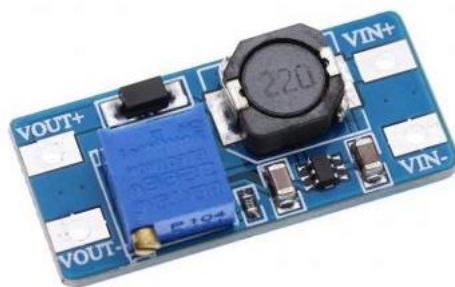
Εικόνα 22: Διάταξη μετατροπής-ενίσχυσης σταθερής τάσης MT3608.
