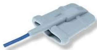
Εικόνα 9β: Finger probe που περιέχει τα ηλεκτρονικά στοιχεία των εκπομπών φωτός καθώς και του φωτοανιχνευτή.
