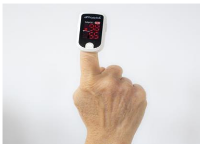
Εικόνα 9α: Finger probe που περιέχει όλα τα ηλεκτρονικά στοιχεία.
