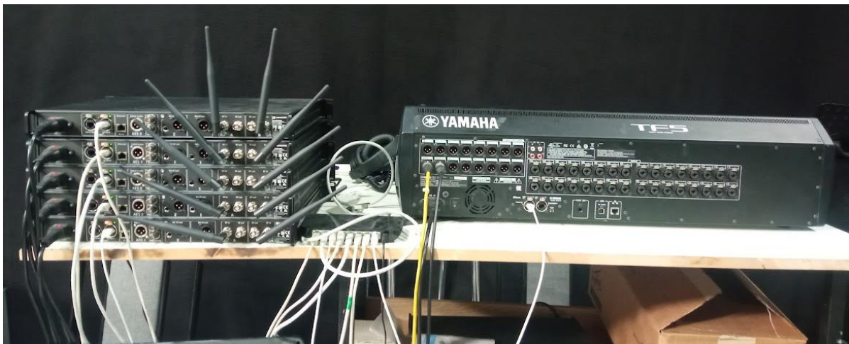
Εικόνα 32: Διασύνδεση των μικροφώνων με καλώδιο δικτύου με πρωτόκολλο Dante
